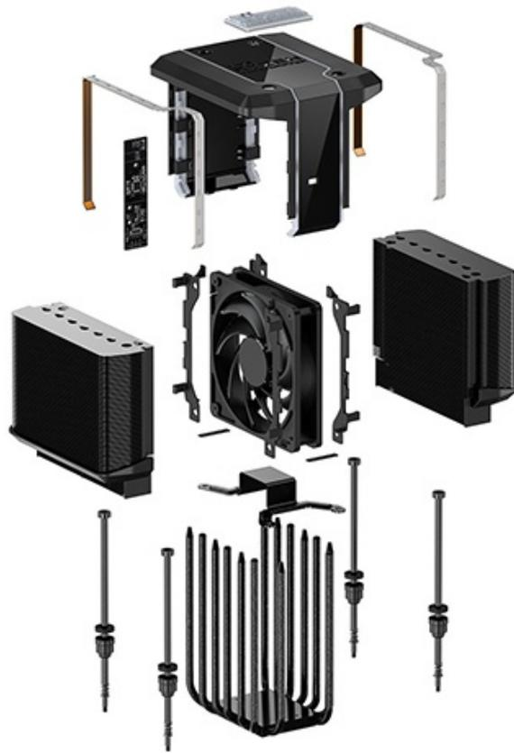
Il sistema di fissaggio, inoltre, permette di smontarlo e rimontarlo in pochi secondi data la presenza di viti molto lunghe sulle quali si può agire direttamente dalla parte alta del dissipatore.
