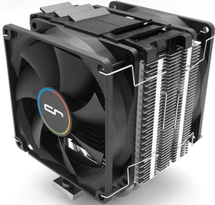
Il modello M9 Plus, invece, essendo basato sui CRYORIG M9i e M9a, è un dissipatore che, nonostante le dimensioni ultra compatte, di soli 98,4x102x124,61mm (LxPxA), ed un peso di 505g, è capace di tenere a bada anche le CPU Intel e AMD di fascia alta grazie ad un corpo lamellare fitto coadiuvato da due ventole CR-9225.
