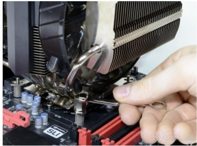
Le staffe per socket Intel dovranno essere fissate alla base del dissipatore tramite le due viti incluse nella confezione.
