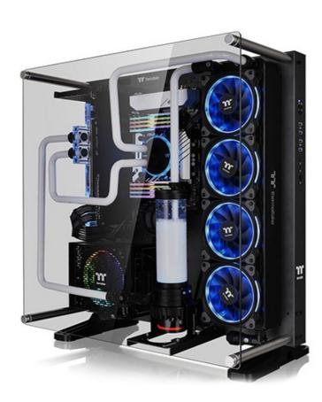
schede madre in formato ATX, schede video lunghe fino a 320mm installabili sia in verticale che in orizzontale, alimentatore da 200mm, fino a quattro drive da 3,5" o 2,5", un radiatore da 420 o 480mm e vaschette tubolari molto capienti.
