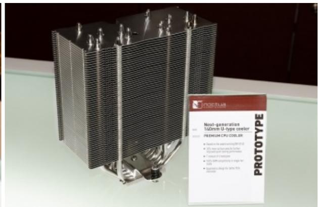
Solito concetto per il D-Type da 150mm, sviluppato sulla base del pluripremiato NH-D15, con ottime prestazioni e basso impatto acustico dovuto ad una minore rotazione delle ventole, e per l'U-Type da 140mm, anch'esso con sette heatpipes e superficie lamellare migliorata.
