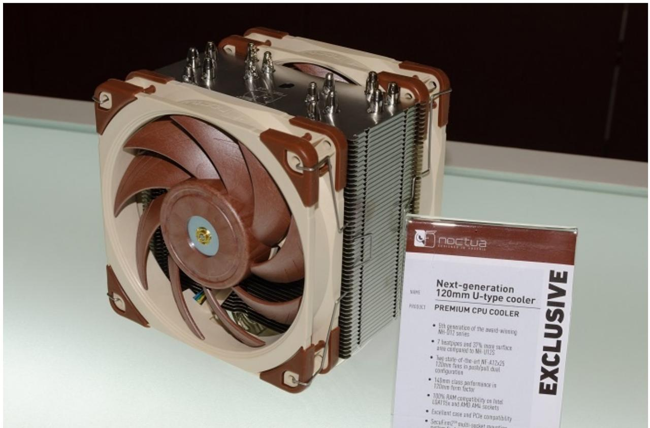
Lasciamoci alle spalle i fondamenti della fisica dei fluidi e passiamo all'offerta Noctua per quanto riguarda il mercato dei dissipatori per CPU con una serie di rinnovati modelli come l'U-Type derivante dal gettonatissimo NH-U12, che offre ora un 37% in più di superficie dissipante ed una ulteriore heatpipe.
