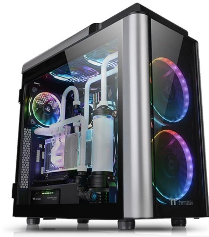
Va da sé che in un prodotto del genere non vi è alcuna restrizione dal punto di vista hardware data la possibilità di montare una scheda madre E-ATX, schede video lunghe sino a 410mm, alimentatori da 220mm, dissipatori a torre alti sino a 200mm e, per finire, dieci drive da 2,5" o sette da 3,5".
