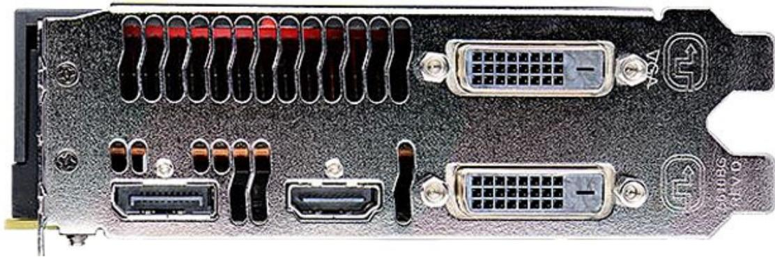
A differenza delle precedenti schede video, la R9 290X consente il collegamento di 3 monitor digitali senza l'utilizzo delle connessioni DisplayPort, semplificando notevolmente le configurazioni AMD Eyefinity che sono da sempre vincolate a questa specifica interfaccia, purtroppo ancora poco diffusa.
