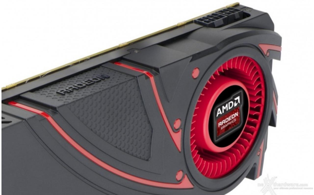
Per alimentare correttamente la AMD Radeon R9 290X è necessario collegare un cavo di alimentazione PCI-E 6pin e un cavo PCI-E 8pin.
