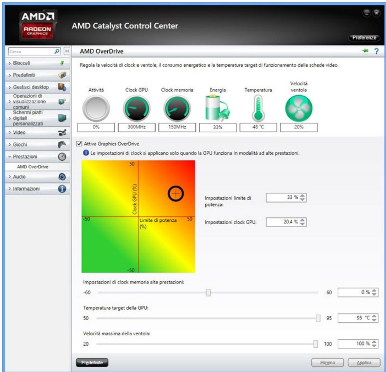
Con la Radeon R9 290X, AMD rinnova il modo di overclockare le proprie schede video, abbandonando il concetto di frequenza fissa e fornendo all'utente la possibilità di specificare un incremento percentuale rispetto alla massima frequenza normalmente raggiunta dalla scheda video a default.↔
