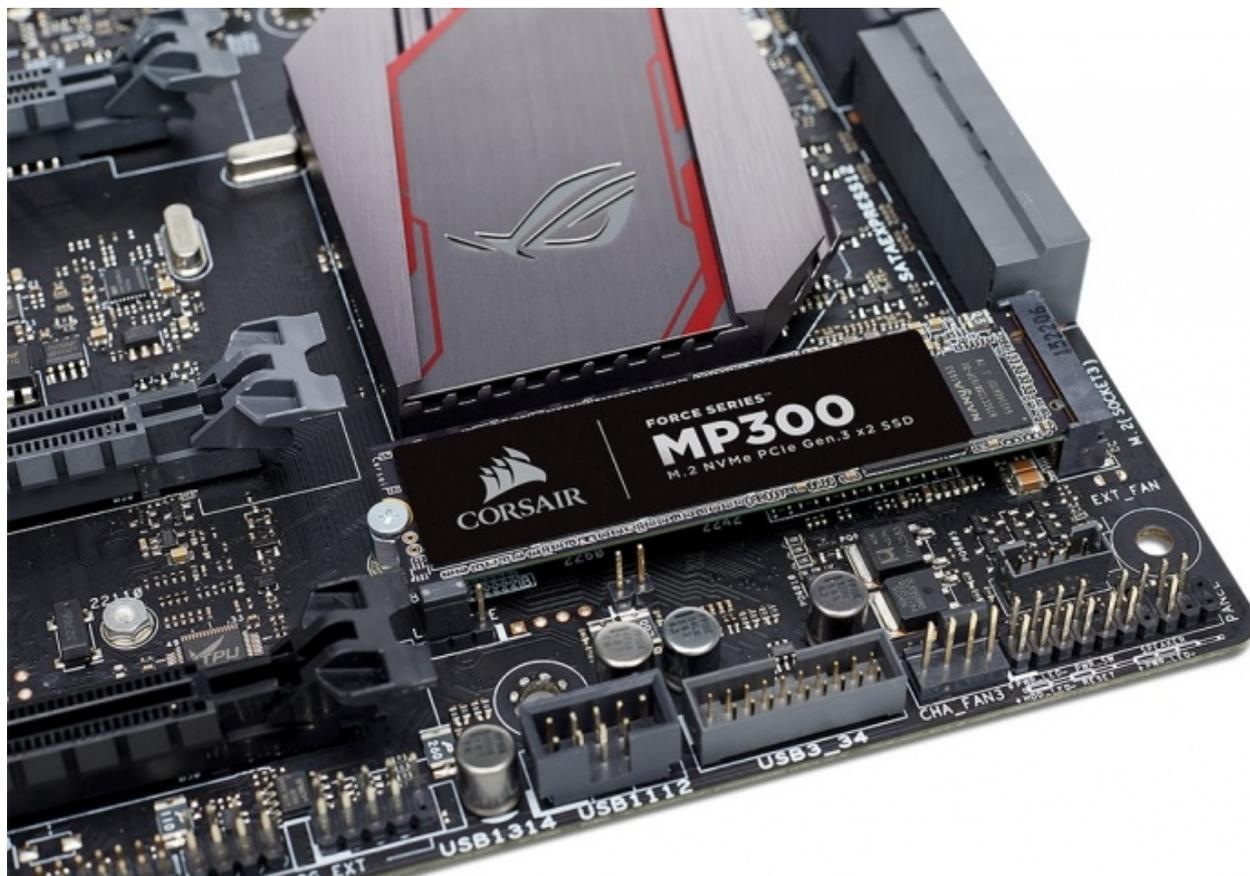
Il Force MP300 supporta l'Enhanced Error Correction (ECC) ed il Wear Leveling statico e dinamico per migliorare la sicurezza dei dati e l'usura omogenea delle celle di memoria nel tempo.
