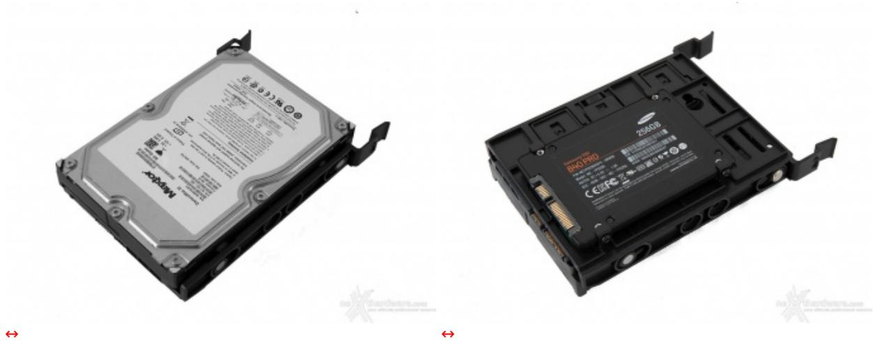
Dopo aver inserito un Hard Disk in modalità completamente tool-less, si può tranquillamente montare un SSD sulla parte inferiore bloccandolo ai supporti con quattro viti.
