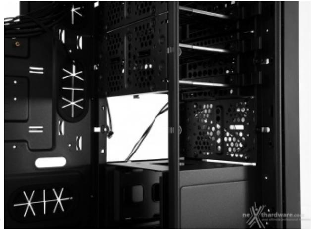
Il disaccoppiamento delle due superfici risulta utile qualora si decida di rimuovere una sola paratia per aumentare lo spazio disponibile per le VGA; in tal caso, come visibile sulla foto di destra, la rimozione della sola parte in plastica consente di ridurre l'ostacolo che la stessa presenta al passaggio del flusso d'aria proveniente dall'esterno.↔
