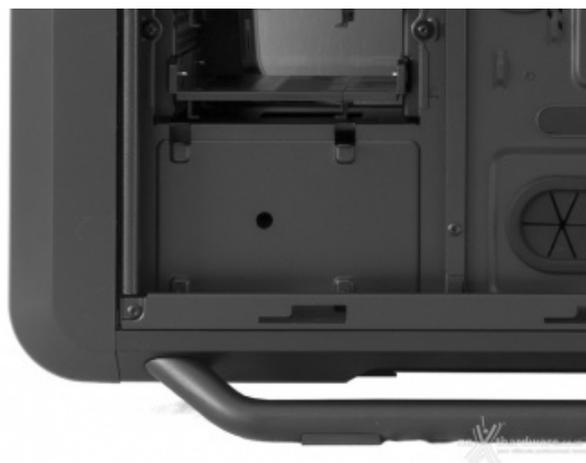
Qualora i drive bay da 2,5" disponibili non fossero sufficienti per le vostre esigenze, sappiate che sul retro del vassoio per la mainboard sono presenti ulteriori due predisposizioni per installare altrettante unità con questo fattore di forma; uno di essi, visibile nella foto di sinistra, è posto in alto in prossimità del primo supporto per HDD, mentre l'altro si trova in prossimità dell'ultimo, nella parte bassa del case.
