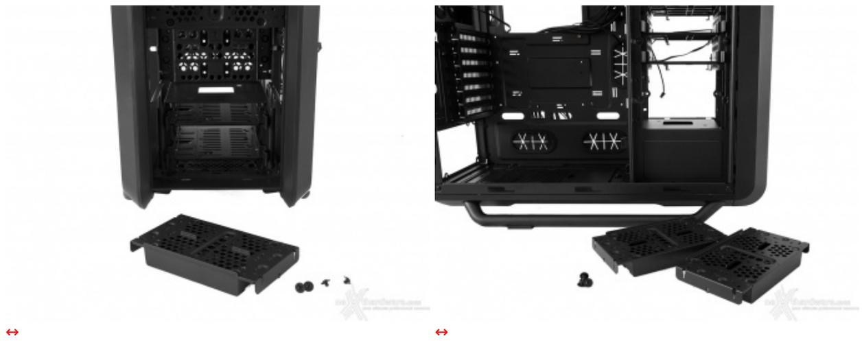
Ciascun supporto è costituito da due robuste paratie, fissate alla struttura con altrettante viti.
