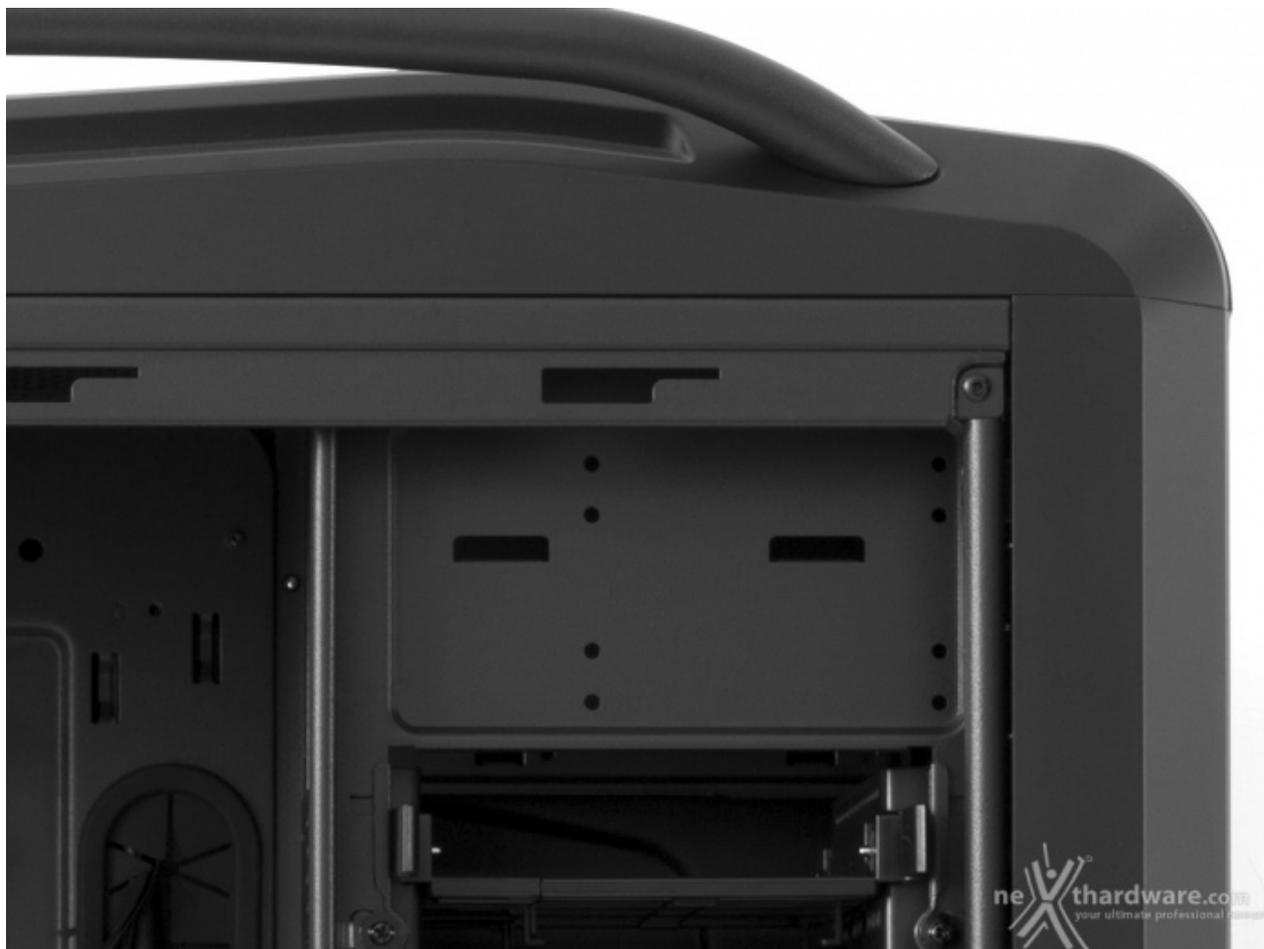
Il Cosmos SE prevede soltanto due bay per periferiche da 5,25" pronti all'uso; per ottenere il terzo bisogna effettuare la rotazione del supporto per HDD sottostante, convertendolo di fatto in un supporto per ODD.
