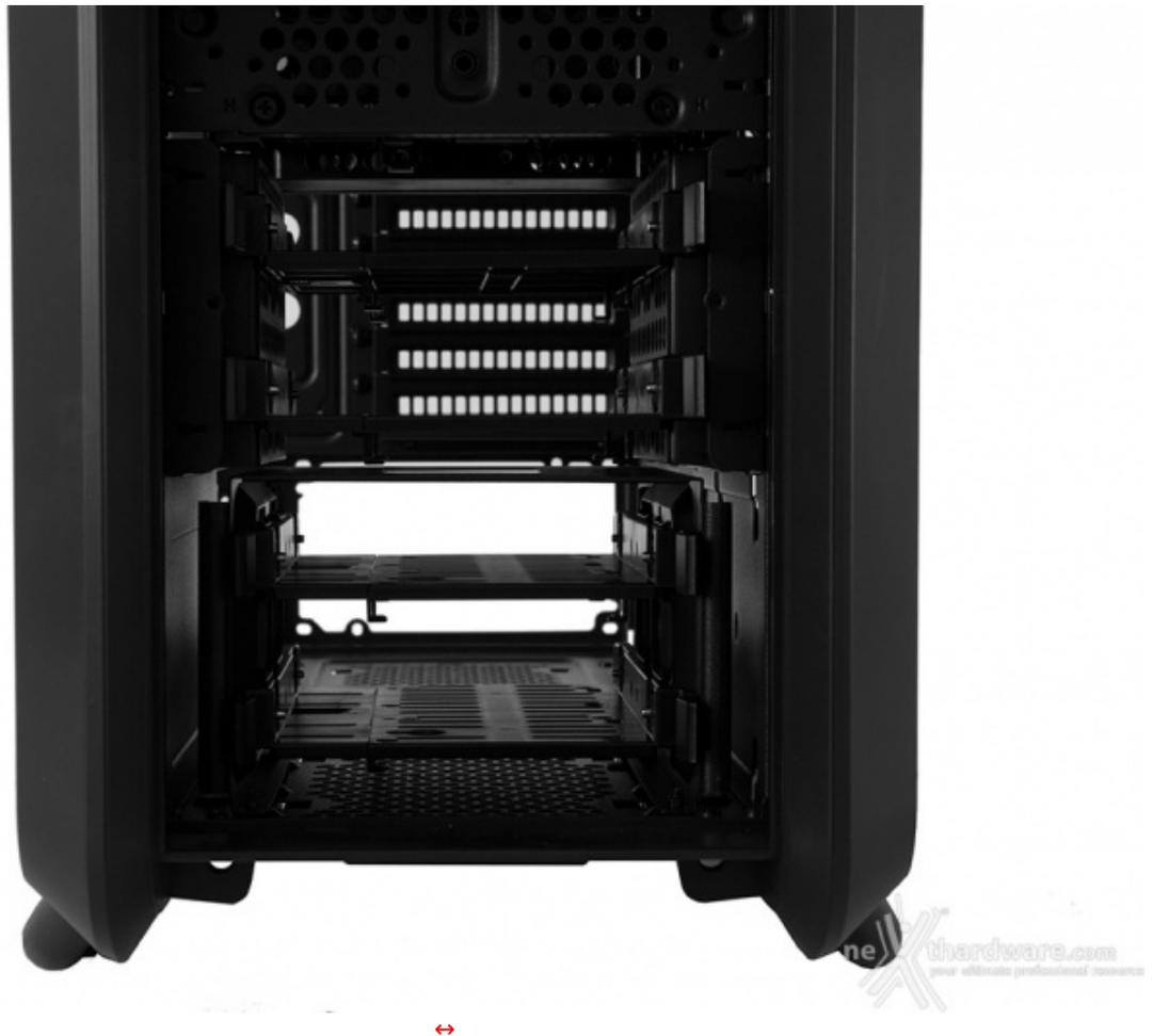
Una volta smontate le due paratie basta rimontarle ruotate di 90°, seguendo le guide presenti sulla struttura, e fissarle con le viti precedentemente rimosse.
