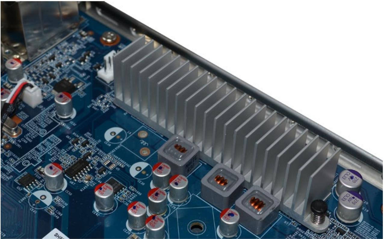
La sezione di alimentazione della scheda madre Shuttle FH87 è composta da sole tre fasi, soluzione decisamente low cost rispetto a quanto si può trovare sulle schede madri tradizionali, ma sufficiente per gestire una CPU top di gamma come l'Intel i7-4770K a frequenze di default.
