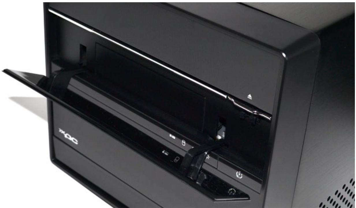
A differenza delle versioni più economiche, questo modello è dotato di una copertura con dispositivo a molla per l'unità ottica, soluzione che consente di non "rovinarne" l'estetica anche quando si installa un lettore Blu-ray o un masterizzatore.
