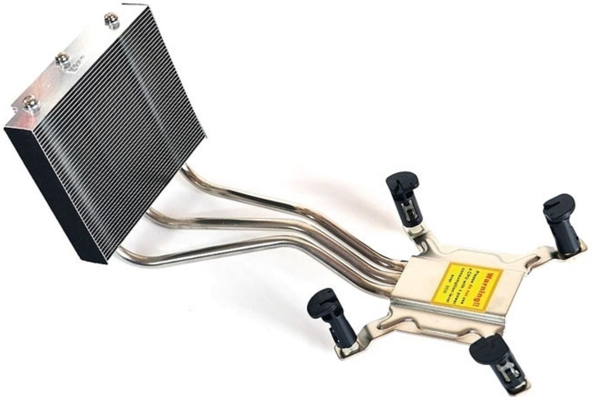
Per il corretto raffreddamento della CPU, Shuttle include nel suo SH87R6 il sistema di raffreddamento Integrated Cooling Engine (I.C.E.), composto da tre heatpipes che rimuovono il calore dalla CPU per dissiparlo su di un ampio radiatore posto sul retro dello chassis.
