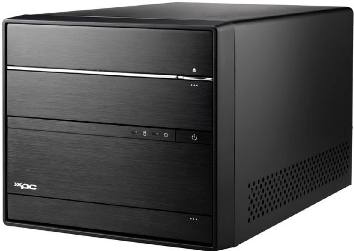
Dal punto di vista strutturale ogni barebone è caratterizzato da un telaio d'alluminio, un cestello per le unità di memorizzazione, un frontale in plastica ed una cover a forma di "U" che andrà a chiudere il sistema.
