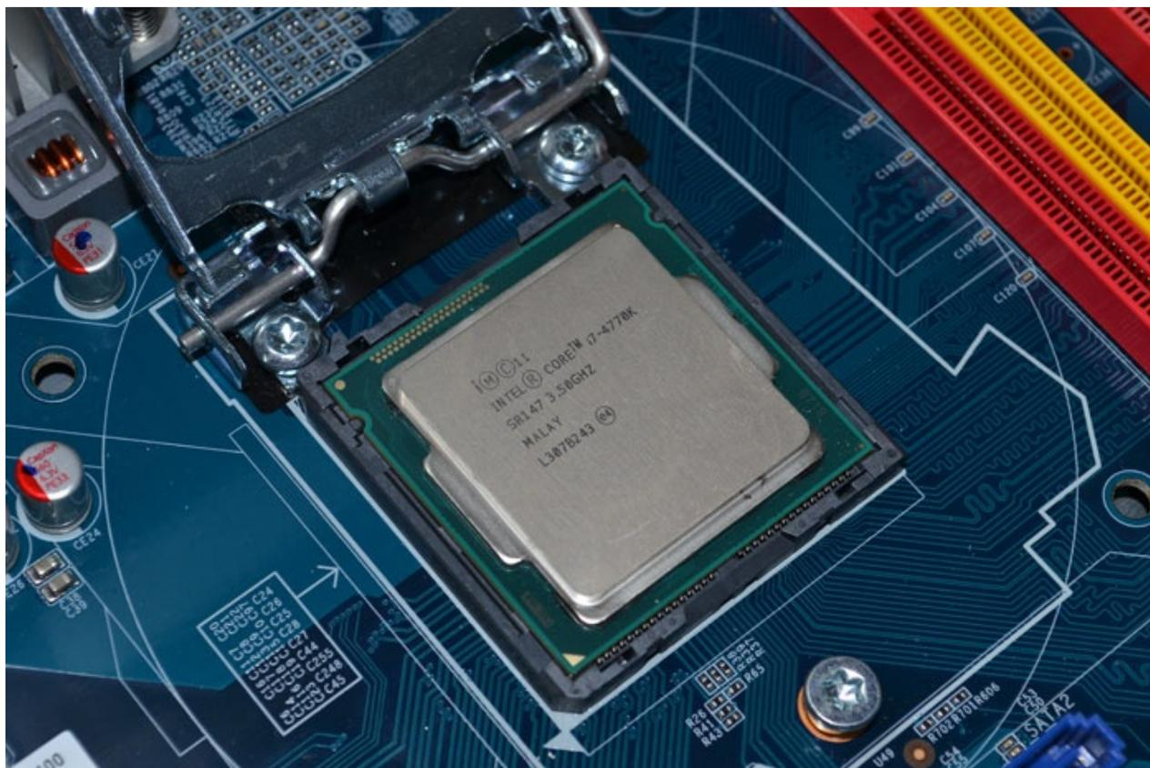
Inclusa nella confezione troviamo un tubetto di pasta termococonduttiva, che deve essere stesa sulla CPU prima di montare il sistema di raffreddamento.
