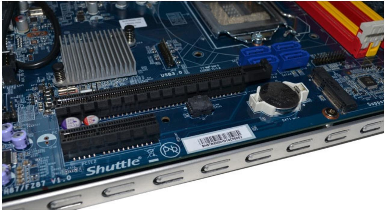
Il supporto alle schede video discrete è garantito dalla presenza di uno slot PCI-E 3.0 x16, pilotato dal controller integrato all'interno della CPU, affiancato da un secondo slot PCI-E 2.0 x4 collegato direttamente al PCH H87.
