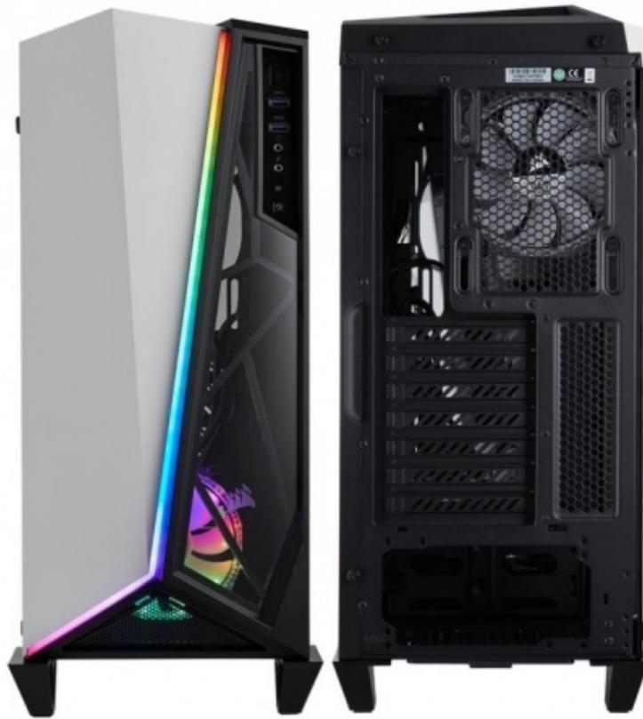
Il nuovo sistema di illuminazione è presente sia nelle due ventole CORSAIR HD120 RGB, montate sul retro e nella parte anteriore, che lungo la copertura frontale dove una bordatura opaca affiancata da 54 LED RGB consentirà di illuminare l'ambiente circostante creando particolari giochi di luce.
