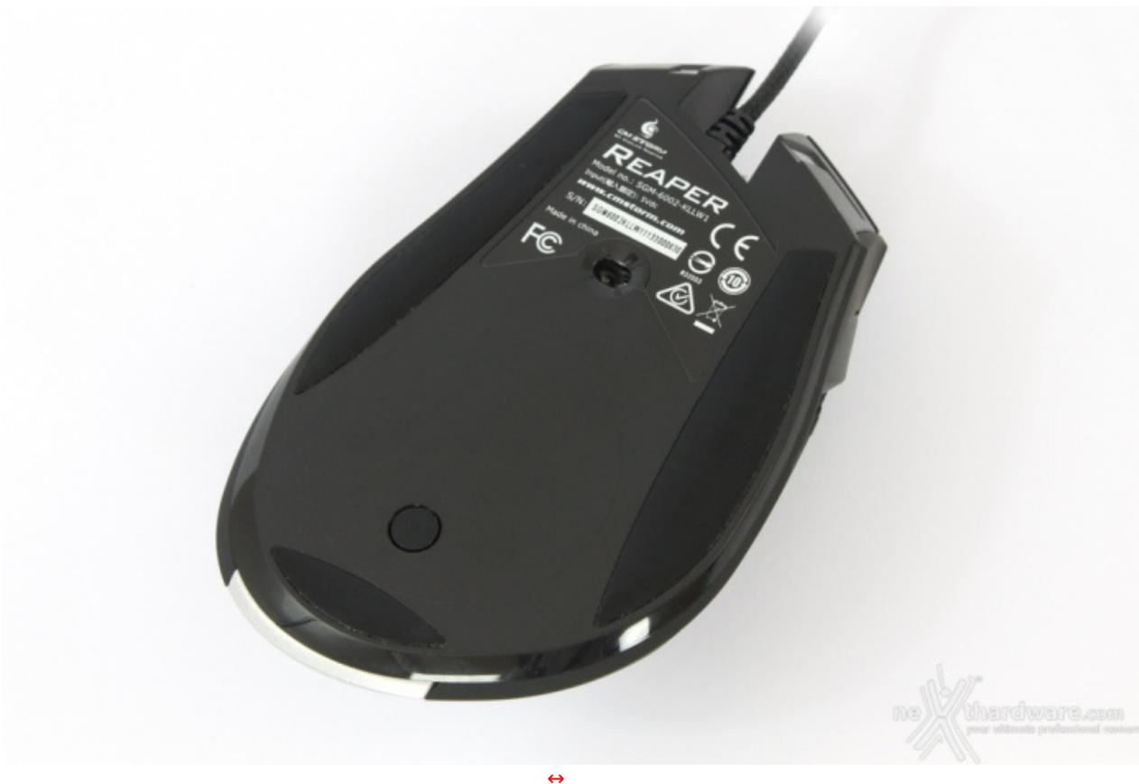
La zona inferiore ci introduce a due aspetti fondamentali e caratterizzanti di un mouse: la posizione del sensore e la forma dei pad surfer.
