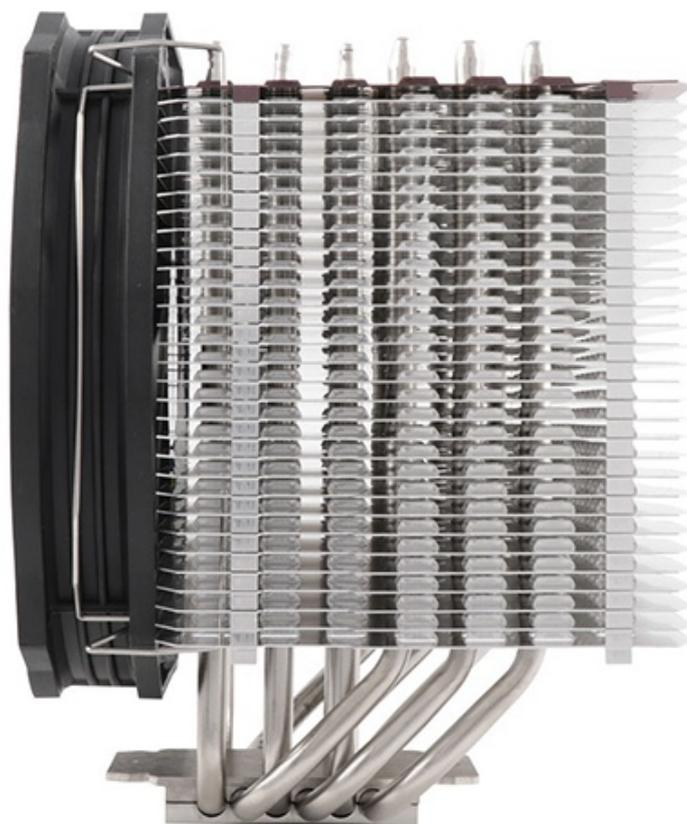
Chiaramente derivato dal modello HR-02 Macho Rev B, il dissipatore è composto da un fitto corpo lamellare raffreddato attivamente da una ventola TY-147 A da 140mm, in grado di variare il proprio regime di rotazione dai 300 ai 1.300 RPM, spostando dai 28.7 ai 125 m<sup>3</sup>/h di aria con una rumorosità massima di soli 21 dB(A).
