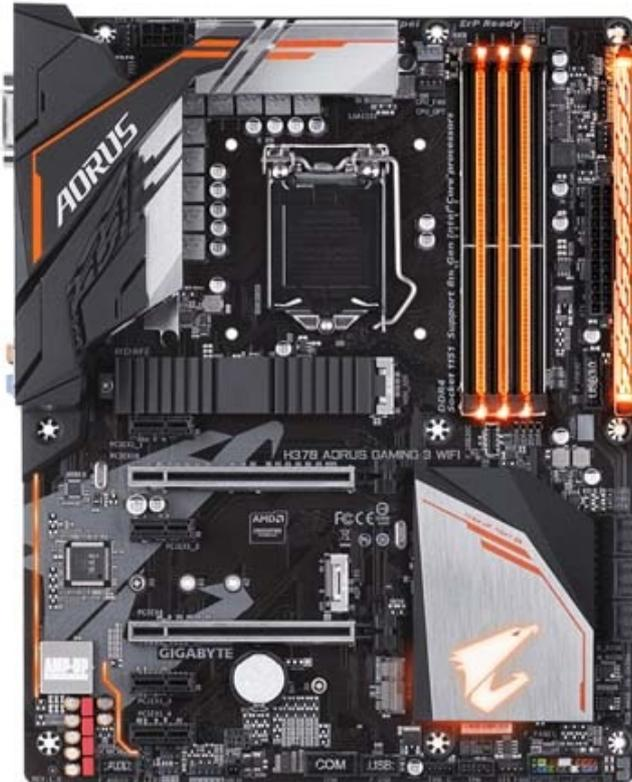
Le schede H370 e B360 AORUS GAMING 3 WIFI integrano un modulo Intel Wireless-AC 9560 con tecnologia CNVi WiFi per supportare le funzionalità wireless 802.11ac e Bluetooth 5.0.
