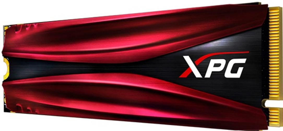
Il nuovo XPG GAMMIX S11 adotta un compatto fattore di forma M.2 2280 ed è dotato di un dissipatore di calore dal look molto accattivante che è in grado di mantenere le temperature del drive in un range ottimale per fornire le massime prestazioni.
