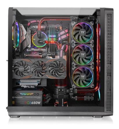
Gli appassionati dei sistemi di raffreddamento a liquido potranno, quindi, usufruire di un radiatore da 280 o 360mm posizionato anteriormente, uno da 120mm posteriormente e uno da 360 o 420mm a destra della mainboard.
