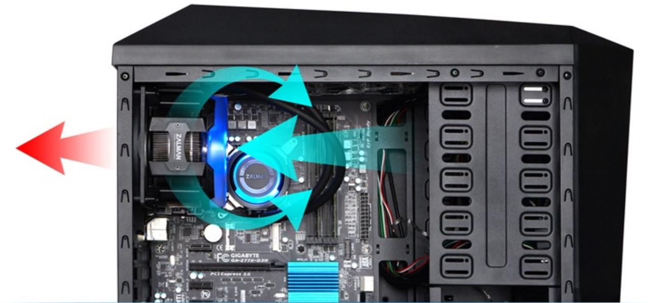
La ventola priva di frame, unitamente ad una struttura quasi interamente aperta del radiatore, oltre a dissipare il calore, genererà un flusso d'aria laterale che andrà a raffreddare le fasi di alimentazione della scheda madre (Voltage Regulator Module).
