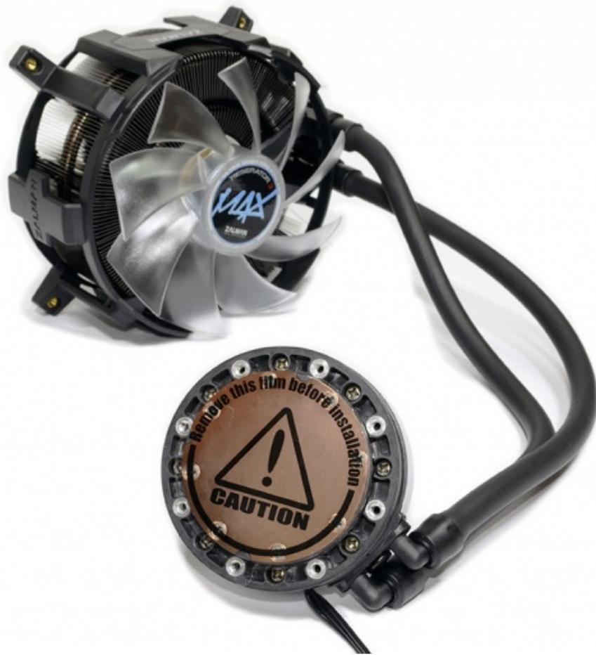
La piastra di rame, fissata al top in Delrin con una serie di viti circolari, non è dotata di un pad termico preapplicato, lasciando all'utente la possibilità di "dosare" la pasta termica inclusa in bundle o applicarne un'altra a suo piacimento.
