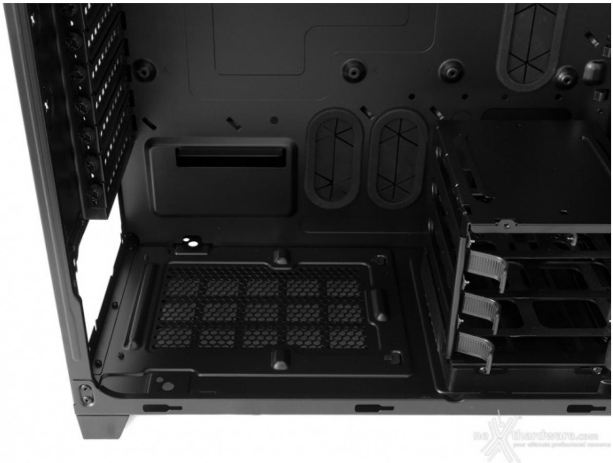
Il vano per l'alimentatore è abbastanza ampio, ma per installare unità di dimensioni superiori alla media (oltre i 200mm), è necessario procedere alla rimozione del cestello adiacente e del relativo supporto in plastica ancorato alla base.
