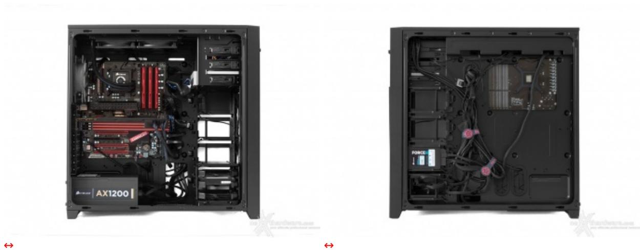
Ed ecco finalmente il Corsair Obsidian 750D ad assemblaggio terminato; come potete osservare, l'installazione di un solo cestello modulare permette di trovare il giusto compromesso fra capacità di archiviazione e potenza di raffreddamento; le zone più calde sono infatti direttamente investite dal flusso di aria fresca proveniente dall'esterno, spinto dalle potenti ventole frontali.↔
