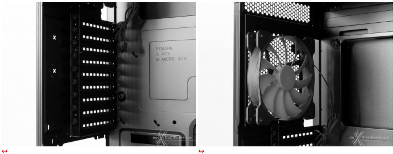
A sinistra sono evidenziati i nove slot di espansione, dotati di comode viti con testa zigrinata, che permettono il montaggio tool-less delle schede; molto belli i frame posti a protezione degli stessi, dotati di fessure per agevolare lo scambio di aria con l'esterno.
