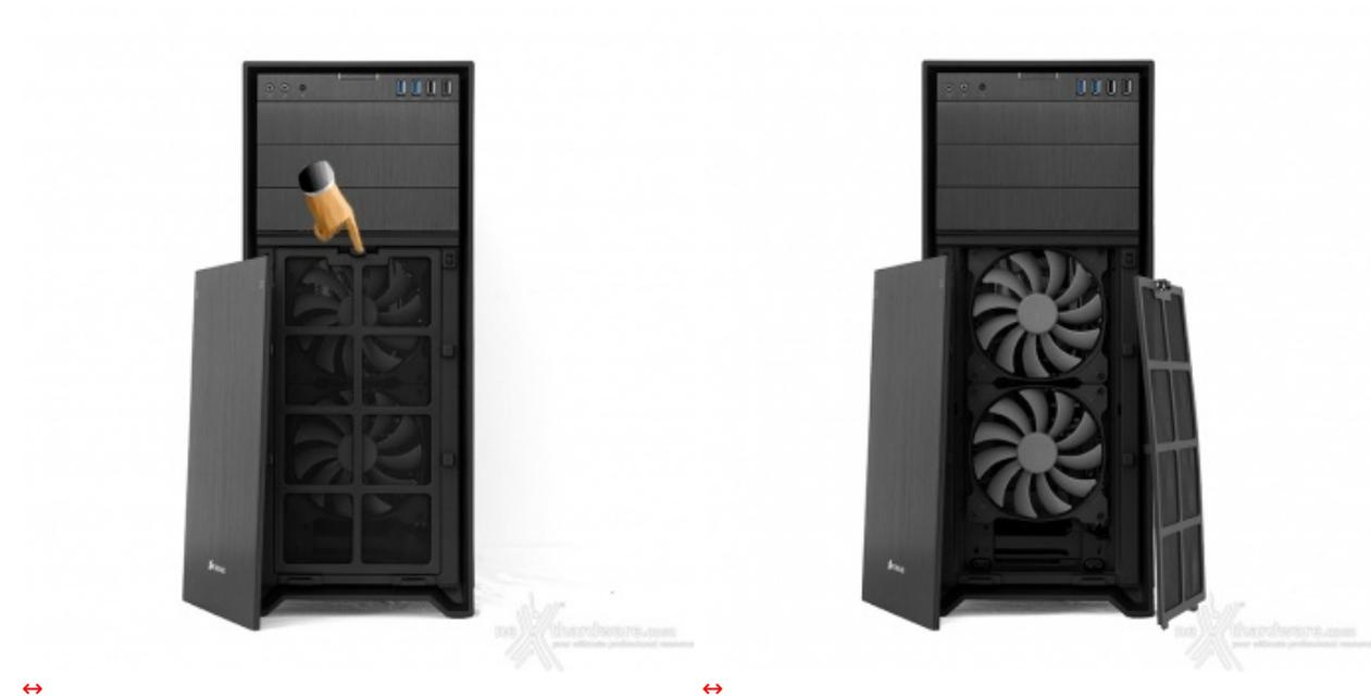
Rimuovendo il pannello abbiamo accesso al filtro antipolvere sottostante, la cui estrazione si effettua premendo verso il basso il gancio di ritenzione posto sulla parte centrale del lato superiore, così da attivare il sistema di sblocco.
