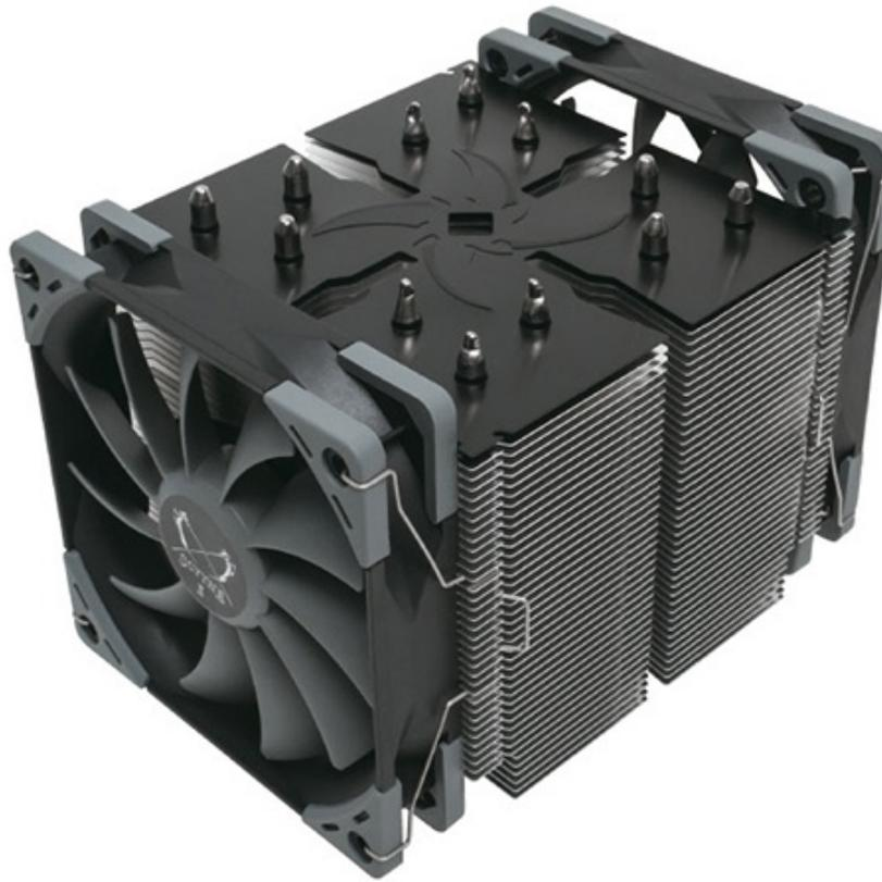
La zona dissipante è raffreddata attivamente da due ventole Kaze Flex 120 PWM poste in configurazione push-pull, in grado di ruotare a basso regime (da 300 a 800 RPM) generando un flusso di aria massimo di 43,03 CFM con una pressione di 0,49 mmH<sub>2</sub>O e soli 14,5dBA di rumorosità , che diventano addirittura 4dBA quando il sistema è a riposo.
