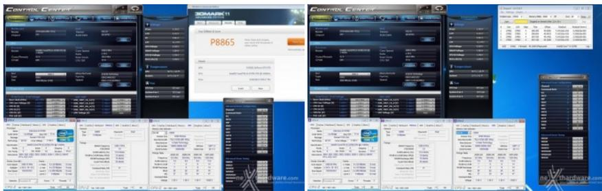
Test di stabilità a 2400MHz 11-13-13-35 1T @ 1,58V
