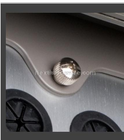
Tutte le viti usate per il fissaggio delle schede sulla mainboard e per tenere in sede il cappello superiore del case, hanno una testa con sagoma cilindrica zigrinata che consente di disassemblare i componenti senza l'ausilio del cacciavite.
