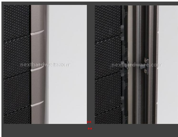
Come giÃ detto in precedenza, gli sportelli anteriori di protezione per lâ€™™ alloggiamento di unitÃ negli slot di espansione, non solo permettono uno smontaggio rapidissimo, ma essendo fatti in metallo e dotati di sistema push-open/close, garantiscono il massimo della protezione da urti accidentali.
