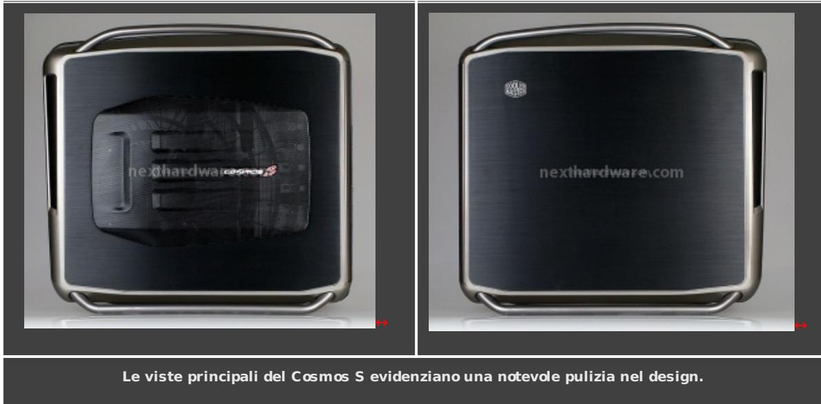
Le uniche parti in acciaio sono costituite dalle mascherine frontali removibili e traforate che nascondono i sette alloggiamenti a vista per le unità da 5,25â€ ; anche le reti copri-ventola superiore e laterale sono in acciaio ma essendo anchâ€™™ esse traforate non incidono particolarmente sul peso complessivo che, senza alcun componente interno, è di circa 13 kilogrammi.
