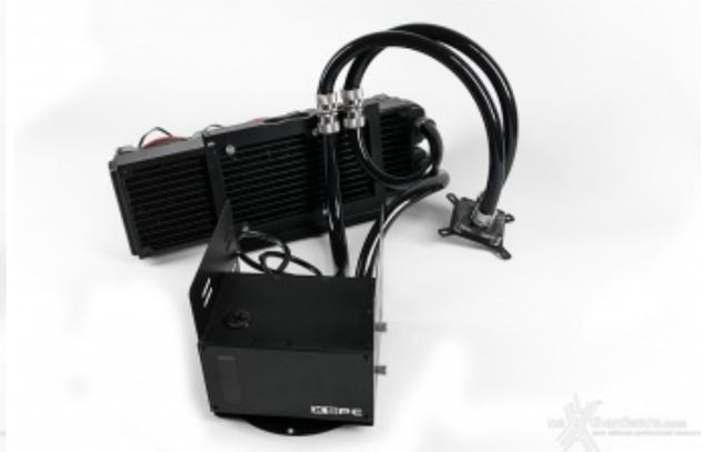
Il kit a liquido da noi scelto è composto da vaschetta e pompa integrata da disporre nel supporto frontale da 5,25", tubi di grande diametro, radiatore "triventola" ed un waterblock EK Supreme.
