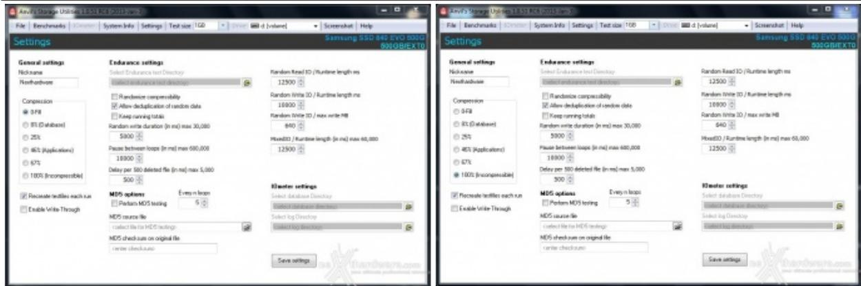
Per i nostri test abbiamo scelto i due pattern che simulano uno scenario che prevede l'utilizzo di dati completamente comprimibili e quello opposto che prevede l'utilizzo di dati non comprimibili.
