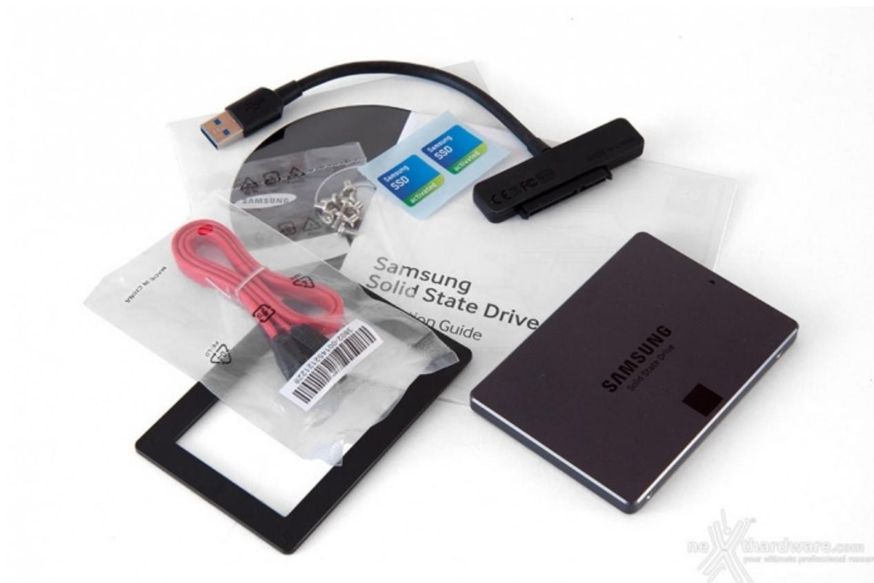
Come potete osservare nell'immagine in alto, il bundle del **Laptop Kit** si differenzia da quello del Desktop kit per il connettore che è SATA->USB 3.0 e per l'assenza dell'adattatore da 2,5"-->3,5", che viene sostituito da una cornice in materiale plastico per aumentare lo spessore del drive e adattarlo, così, ai comuni alloggiamenti presenti nei portatili di precedente generazione.
