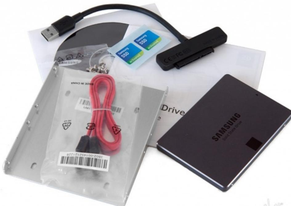
Rispetto alla dotazione della versione Basic, il **Desktop Kit** prevede un pratico adattatore in alluminio e relative viti, che consente l'installazione dell'unità in un bay da 3,5", un cavetto SATA dati ed un adattatore SATA --> USB 2.0, che permette il collegamento dell'unità ad una porta USB durante le fasi di migrazione dei dati dal vecchio HDD al nuovo SSD.↔
