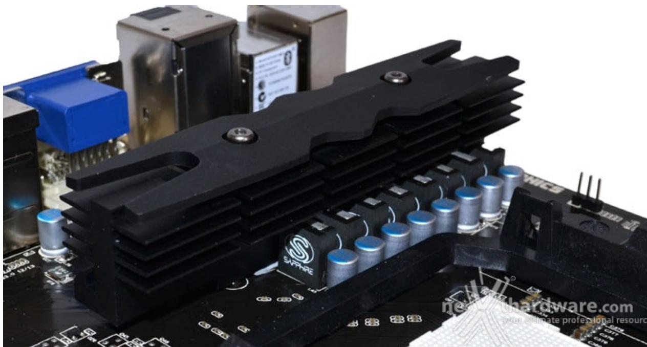
Per garantire il corretto funzionamento delle APU "Trinity" e "Richland", in particolare dei modelli K da 100W, Sapphire ha integrato un circuito di alimentazione ad 8 fasi impreziosito dall'utilizzo di componenti proprietari particolarmente performanti, già utilizzati con successo nelle schede video di fascia alta.
