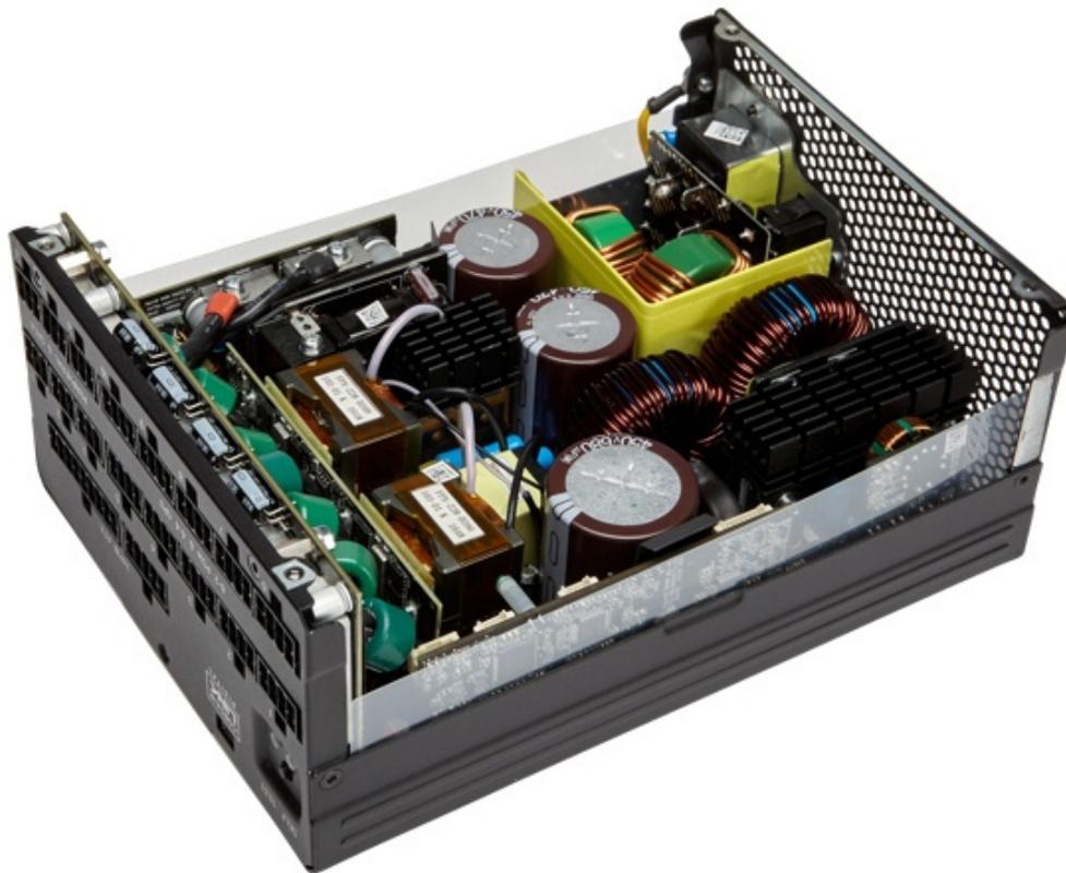
L'utilizzo di transistor al nitruro di gallio ed i condensatori di produzione giapponese con temperatura massima operativa di  $105 \leftrightarrow ^\circ\text{C}$  consentono, insieme a tutti gli altri componenti, di erogare ininterrottamente 1600W.
