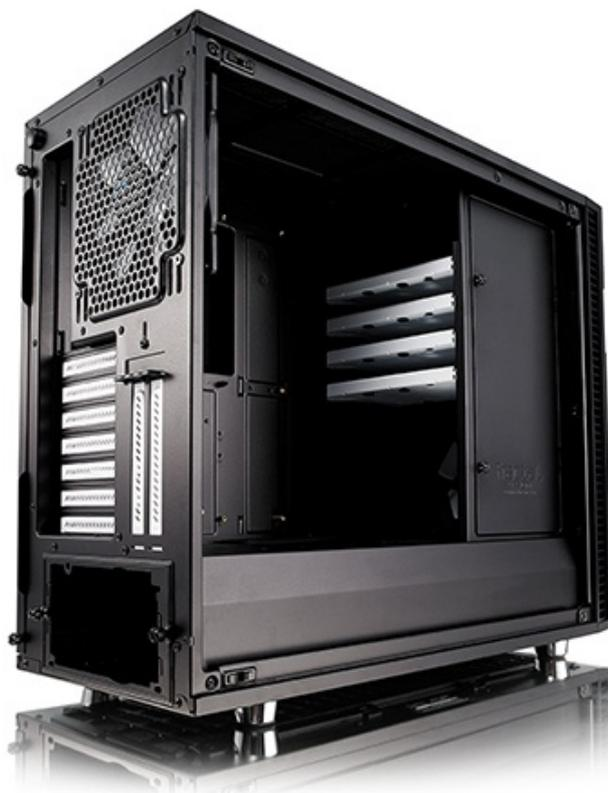
Seppur apparentemente simile ai predecessori, il nuovo R6 vanta un telaio totalmente rivisto al fine di integrare un robusto pannello in acciaio che potrà essere posizionato sia a sinistra che a destra per nascondere una gran mole di drive, nel primo caso, o per integrare radiatori di generose dimensioni, nel secondo.
