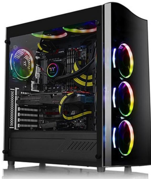
Particolare attenzione è stata posta anche alla pulizia interna del case, che resterà molto pulito grazie all'ausilio di filtri antipolvere integrati nel pannello frontale, un filtro in mesh calamitato posizionato sul top e uno removibile per l'alimentatore.
