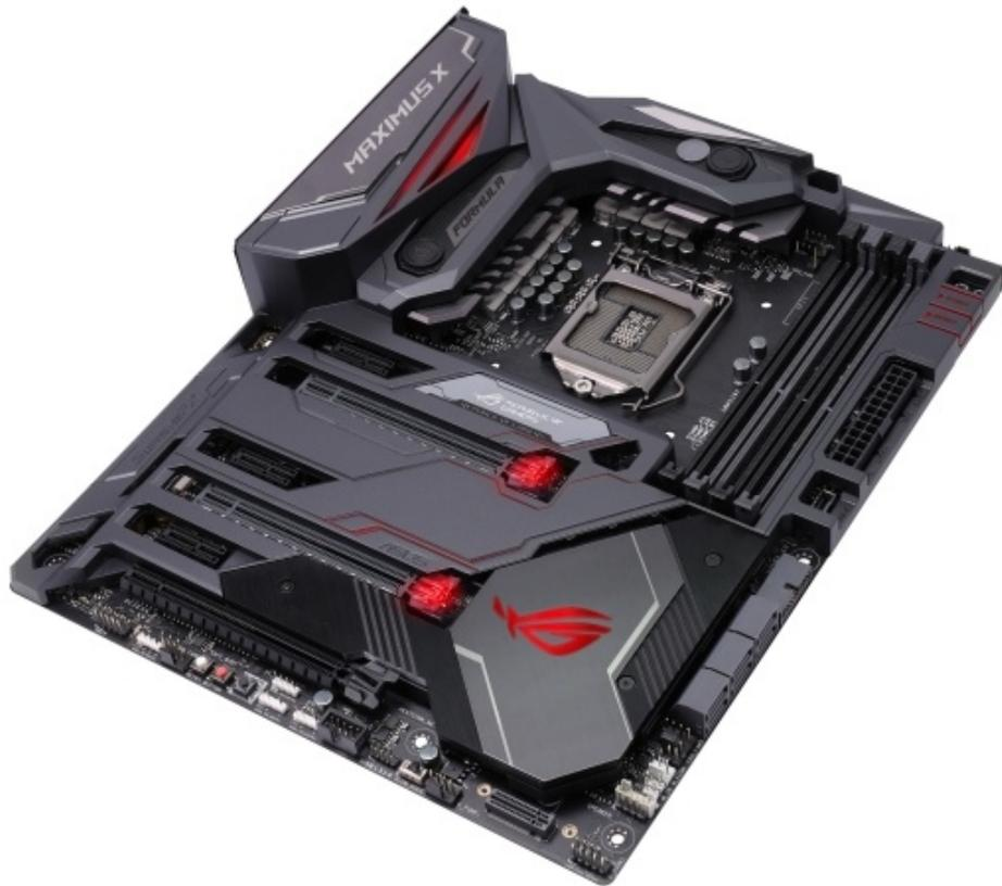
Eccellenti le doti di connettività offerte grazie al supporto a tutti i più recenti protocolli di trasmissione dati rese possibili da sei porte SATA III, sei USB 3.0, sei USB 2.0, tre USB 3.1 e ben due connettori M.2 PCIe 3.0 x4.
