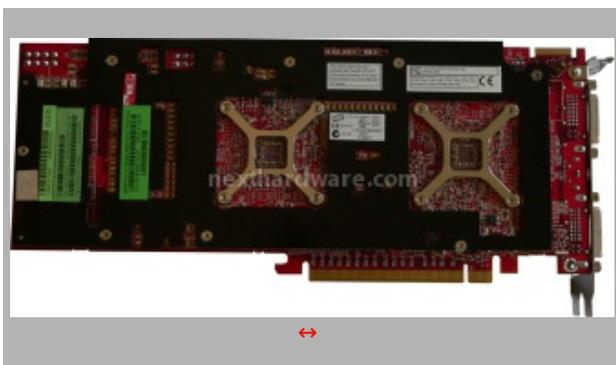
Sul retro della VGA sono ben identificabili i supporti dei dissipatori che sovrastano le due GPU R680. Le ram sono dissipate da una placca di alluminio verniciato di nero, che riveste anche un ruolo protettivo per la maggior parte del pcb. In alto a destra è visibile l'unico connettore CrossFireX presente, necessario per collegare una seconda VGA in caso si desiderasse costruire un sistema dotato di ben 4 GPU.
