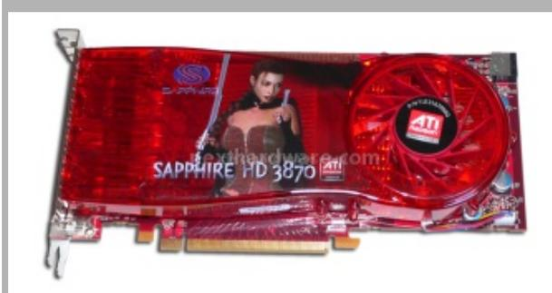
La Sapphire HD3870 512MB, segue il reference ATI, è dotata di un dissipatore doppio slot e non è di dimensioni eccessive, è lunga infatti 23 cm e pesa 600 grammi.
