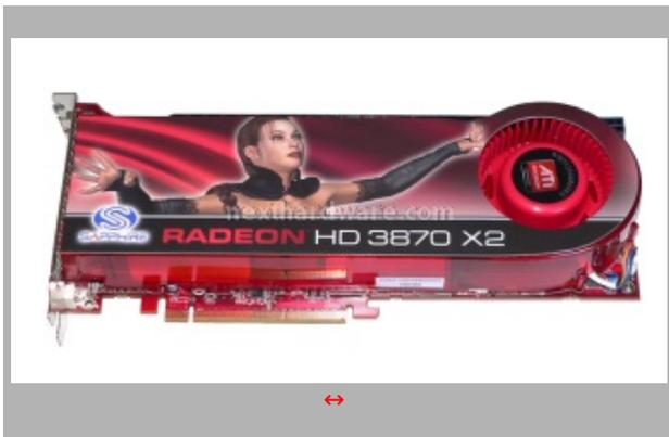
La Sapphire HD3870 X2 1GB ricalca, anche in questo caso, la reference board AMD. La scheda è imponente, lunga 27 cm, eguagliando le dimensioni della nVidia 8800 ULTRA e GTX; il peso invece è maggiore, alla prova della bilancia il risultato è stato da record, ben 1,3 KG.
