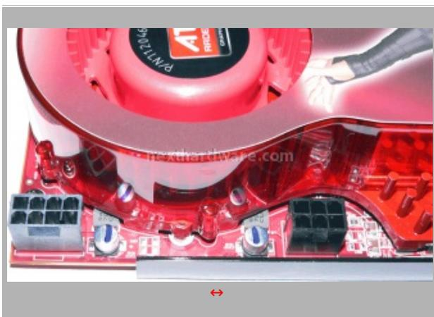
La scheda video necessita di ben due alimentazioni aggiuntive, una connessione 6 pin PCI-E e una 8 pin PCI-E. L'elevato consumo energetico è diretta conseguenza dell'utilizzo di due GPU sullo stesso pcb, i consumi complessivi non si discostano, però, da un sistema CrossFire di pari caratteristiche.
