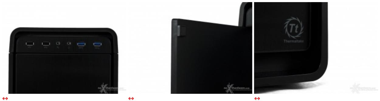
In alto a sinistra osserviamo il pannello delle connessioni, che comprende, da sinistra verso destra, due porte USB 2.0, due ingressi jack per microfono e cuffie, oltre a due porte USB 3.0.
