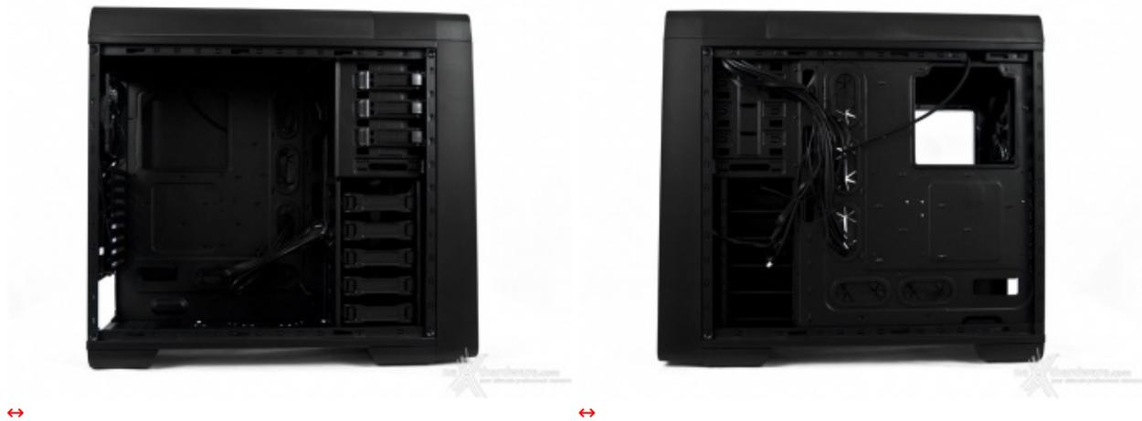
Il vassoio interno permette di ospitare schede madri in formato E-ATX, Standard ATX e MicroATX, lasciando un discreto spazio di manovra ai lati delle stesse.
