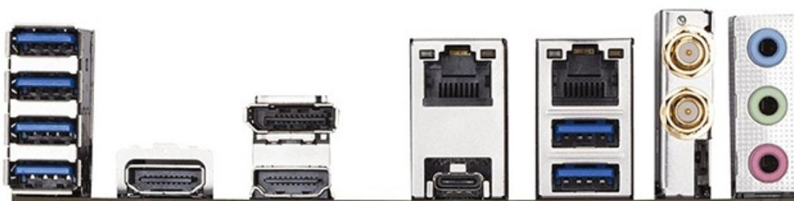
Sul back panel della GIGABYTE Z370N WIFI troviamo due porte HDMI 2.0a ed una DisplayPort che consentono di realizzare configurazioni a triplo schermo dotate di risoluzione 4K Ultra HD con tecnologia HDR.
