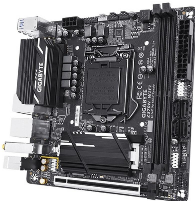
Di ottimo livello le doti di connettività potendo contare su un doppio connettore Intel GbE con supporto alla tecnologia cFossSpeed, un modulo WiFi Dual Band 802.11ac e ben sette porte USB 3.1, di cui una dotata di connettore USB Type-C.
