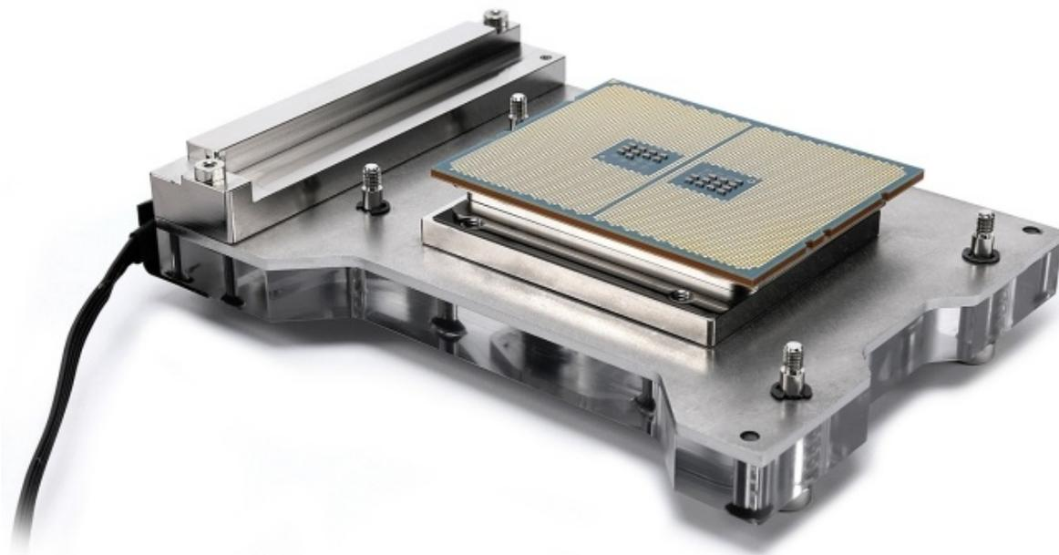
Anche su questo modello abbiamo una piastra di raffreddamento completamente ridisegnata e di maggiori dimensioni per assicurare un miglior contatto meccanico con gli IHS delle CPU Theradripper e, di conseguenza, una migliore dissipazione del calore, nonché una striscia a LED RGB 4 pin compatibile con eventuali controller dedicati e con il sistema di illuminazione AURA SYNC.
