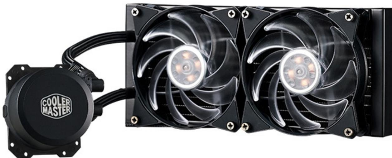
I due AiO sono quasi identici ai modelli base e sono pienamente compatibili con le piattaforme più recenti Intel e AMD (Threadripper esclusa), sono realizzati in alluminio e prevedono l'uso di un blocco pompa/waterblock con tecnologia Dual Chamber che prevede l'installazione di pompa e piastra in rame elettrolitico in due zone distinte tra loro, una sopra l'altra.
