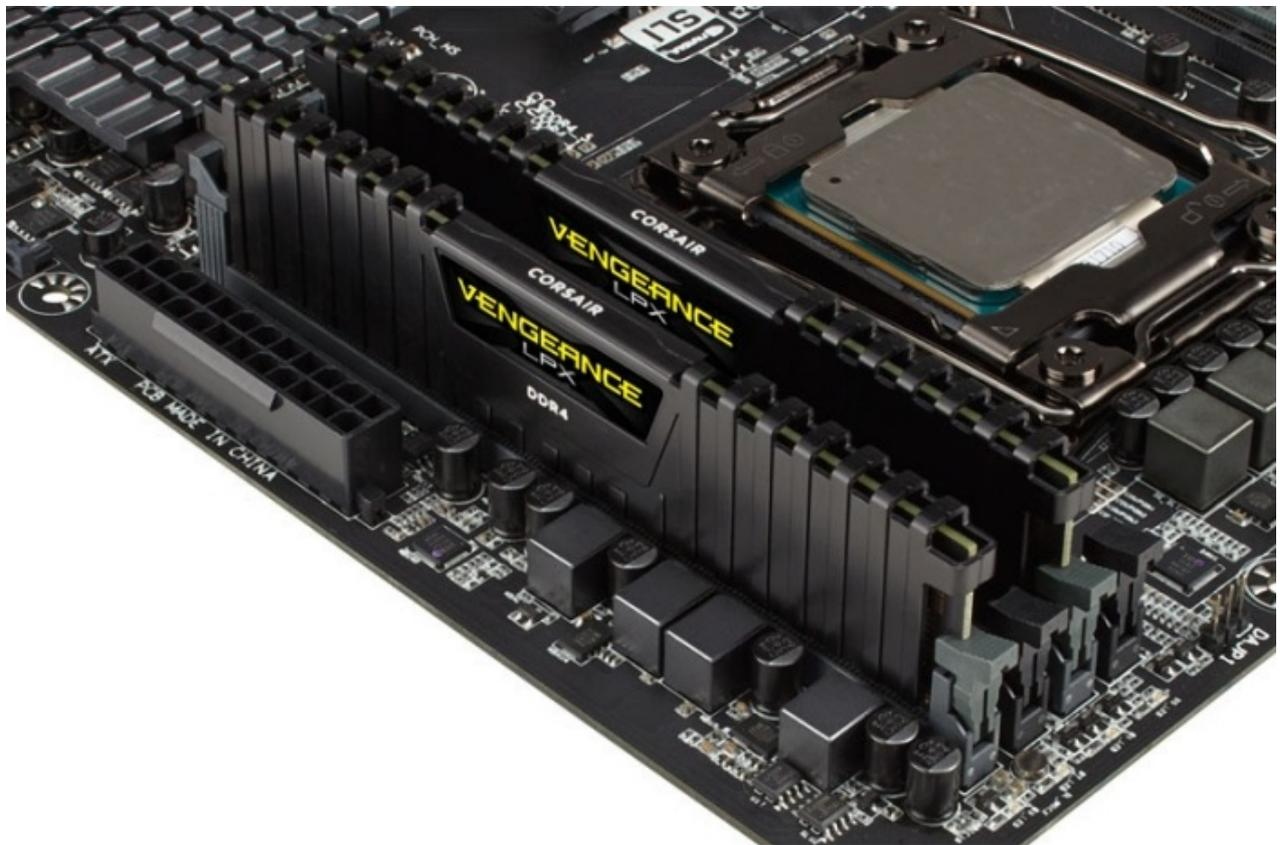
Sviluppate in collaborazione con ASRock e, di conseguenza, validate sulla X299 OC Formula semplicemente attivando il relativo profilo XMP 2.0, le nuove DDR4 sono equipaggiate con ICs Samsung B-Die capaci di prestazioni decisamente elevate.
