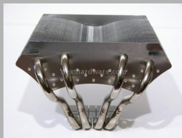
Vista posteriore dove si nota l'imponenza delle 4 Heat Pipe.
