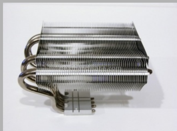
Le 60 fittissime alette che costituiscono il corpo
