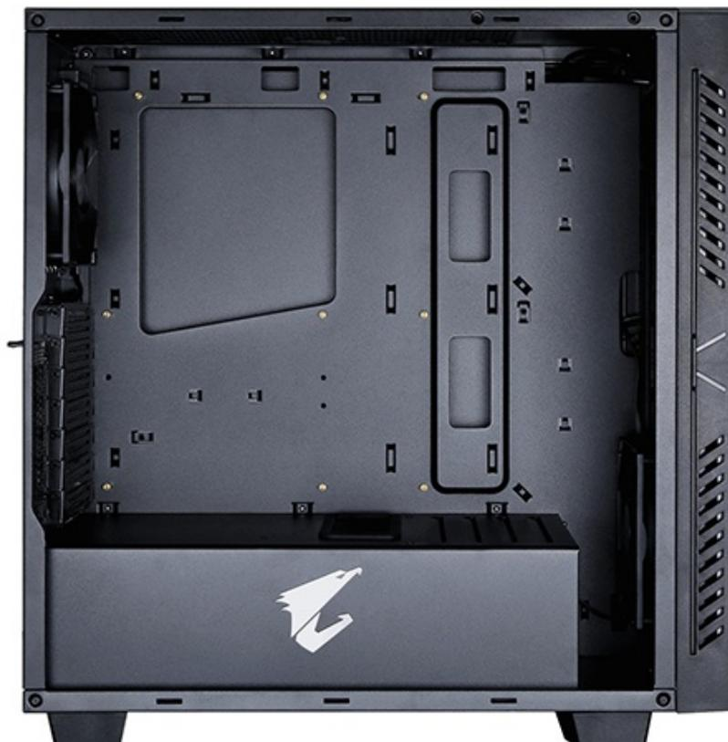
All'interno, il case è in grado di contenere una scheda madre in formato ATX, schede video lunghe 400mm, di cui una installabile parallelamente alla scheda madre (Riser PCI non incluso) e dissipatori ad aria per CPU alti 170mm.
