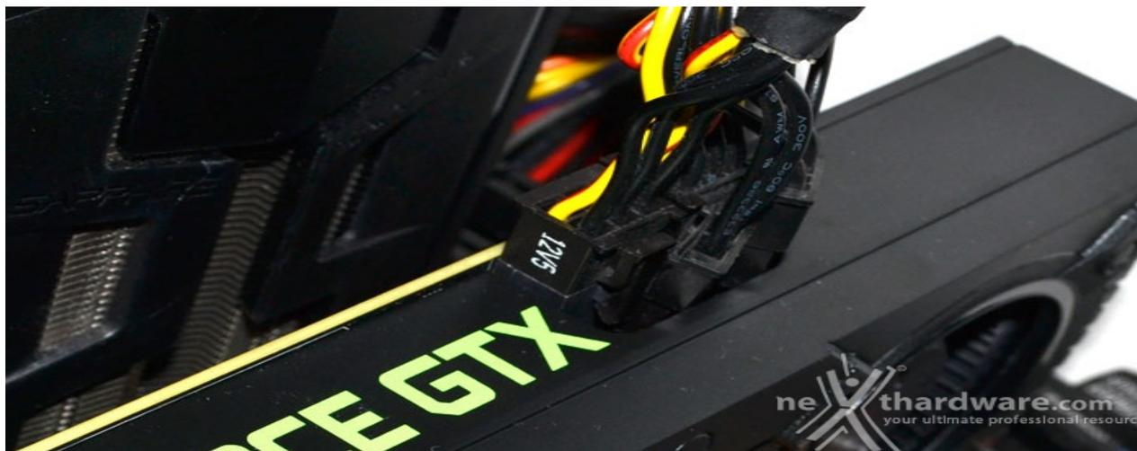
Il posizionamento dei connettori di alimentazione è inusuale per la maggior parte delle altre schede video, ma per la GeForce GTX 760, come per le GTX 660, è una scelta obbligata data la ridotta lunghezza del PCB.
