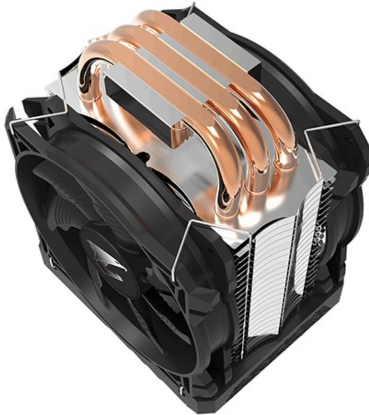
Tre heatpipes per lato, con un diametro di ben 10mm, sono poste a diretto contatto con la CPU e, stando a quanto dichiarato dalla casa produttrice, consentono al dissipatore di smaltire sino a 200W.
