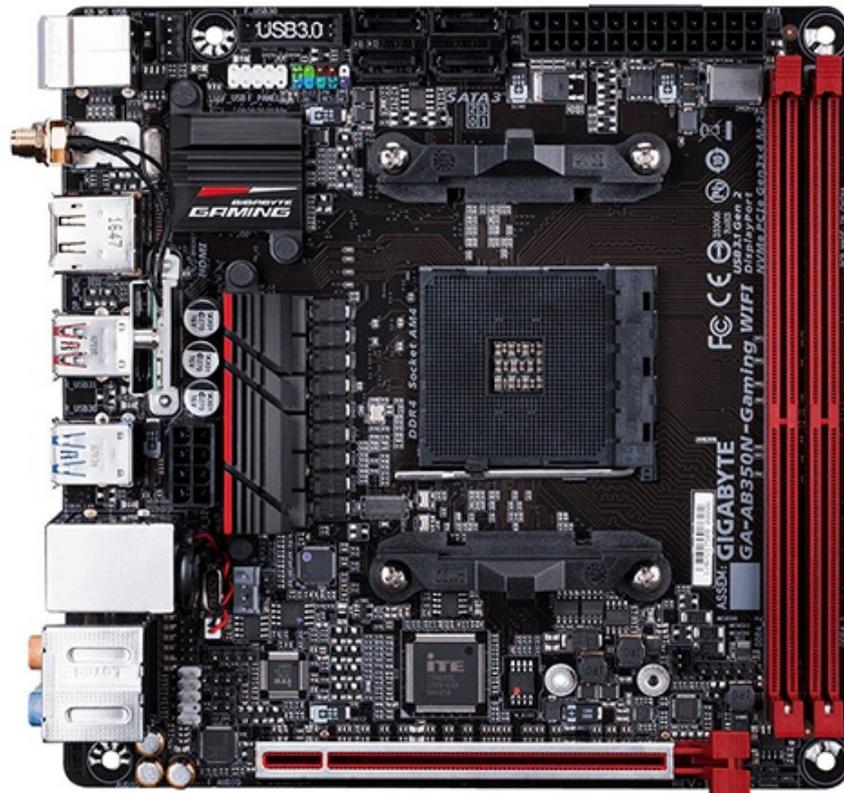
L'audio HD è del tipo a 8 canali ed è basato su un CODEC in grado di garantire un valore di SNR↔ di 120 dBA.
