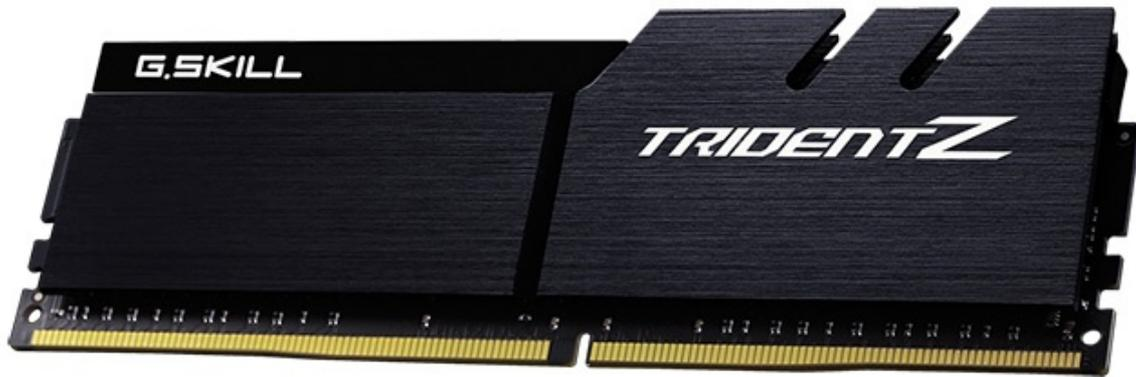
Il kit di punta, formato da due moduli da 8GB ciascuno, abbinabile quindi ai processori Kaby Lake-X in modalità dual channel, vanta una frequenza di targa pari a 4400MHz con timings 19-19-19-39 e sarà disponibile sia nella versione RGB che nella nuova livrea "all black" visibile nell'immagine soprastante.
