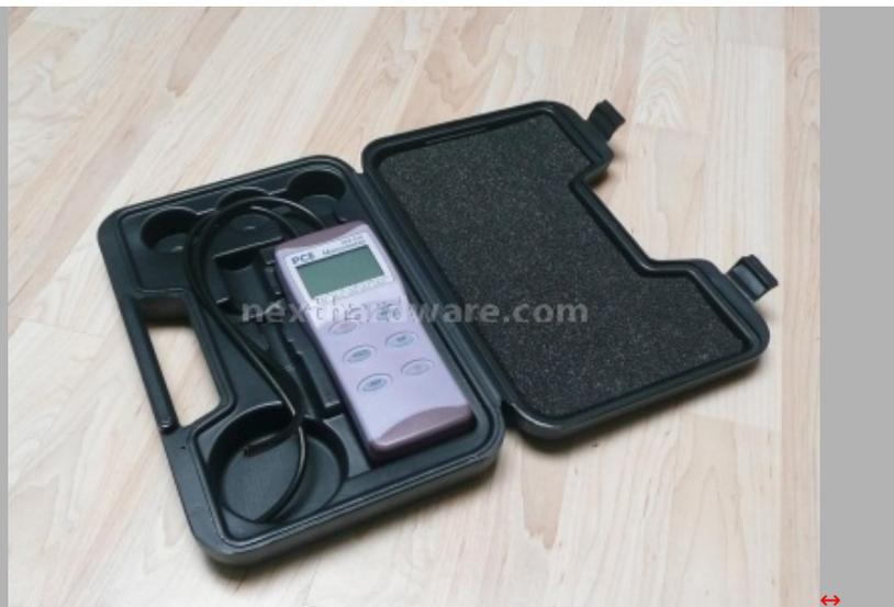
Per svolgere i test di portata abbiamo utilizzato un manometro differenziale digitale PCE P30 (sopra) ed un flussimetro King Instrument (in foto a sx).
