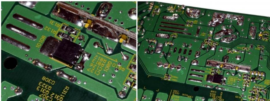
Non si notano componenti di particolare interesse, ad eccezione del diodo [10U45](http://www.diodes.com/datasheets/sbr/SBR10U45D1.pdf) (<http://www.diodes.com/datasheets/sbr/SBR10U45D1.pdf>) che funge da rettificatore per la tensione di stand-by; con i suoi 10A nominali è perfettamente in grado di fornire quanto dichiarato dal costruttore.
