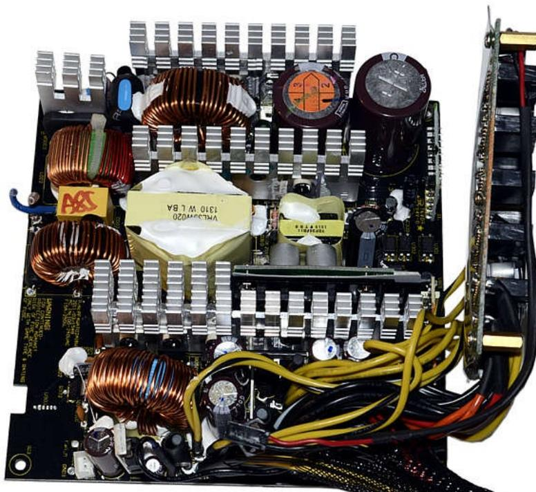
Sebbene l'utilizzo del cablaggio fisso, anche solo per il cavo ATX ed EPS, porta via dello spazio, le ridottissime dimensioni dei dissipatori rendono possibile l'utilizzo di una folta componentistica.
