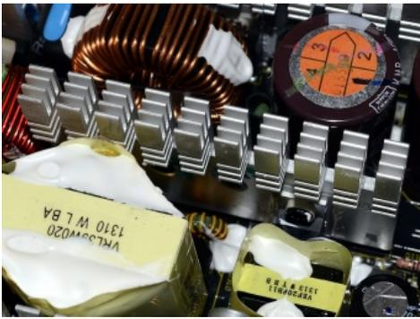
Particolare del dissipatore dello stadio primario di switching.
