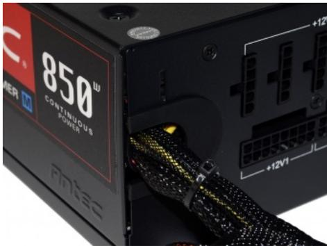
Il foro di uscita del cablaggio fisso è bordato su tre dei quattro lati da un profilo in morbida gomma; tale soluzione riduce efficacemente gli effetti dello sfregamento in caso di ripetuti movimenti.
