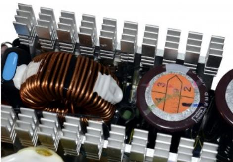
Particolare del dissipatore dedicato ai Mosfet del sistema di controllo del fattore di potenza.
