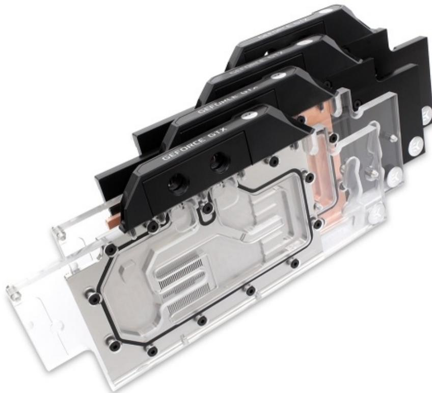
Esattamente come il performante Supremacy EVO per CPU, anche i GTX FE Full Cover sono progettati con un design interno a bassa restrizione (così da poter essere abbinato anche a pompe a bassa portata) e prevedono un unico ingresso centrale di tipo split-flow che mantiene inalterate le prestazioni di raffreddamento anche in caso di flusso del liquido rovesciato.
