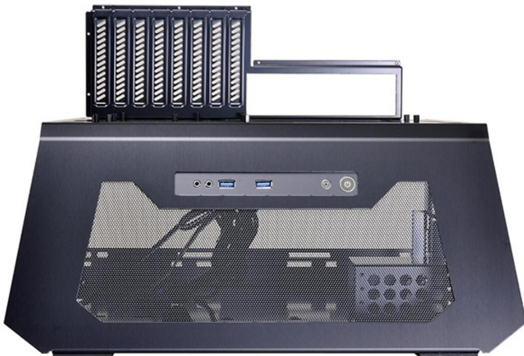
Il Test Bench PC-T70, realizzato in alluminio e acciaio, pesa circa 2.95kg, ha dimensioni pari a 432x316x416mm (LxAxP) e dispone, lungo una delle facciate, di due porte USB 3.0, due jack HD audio e pulsanti di accensione e reset.
