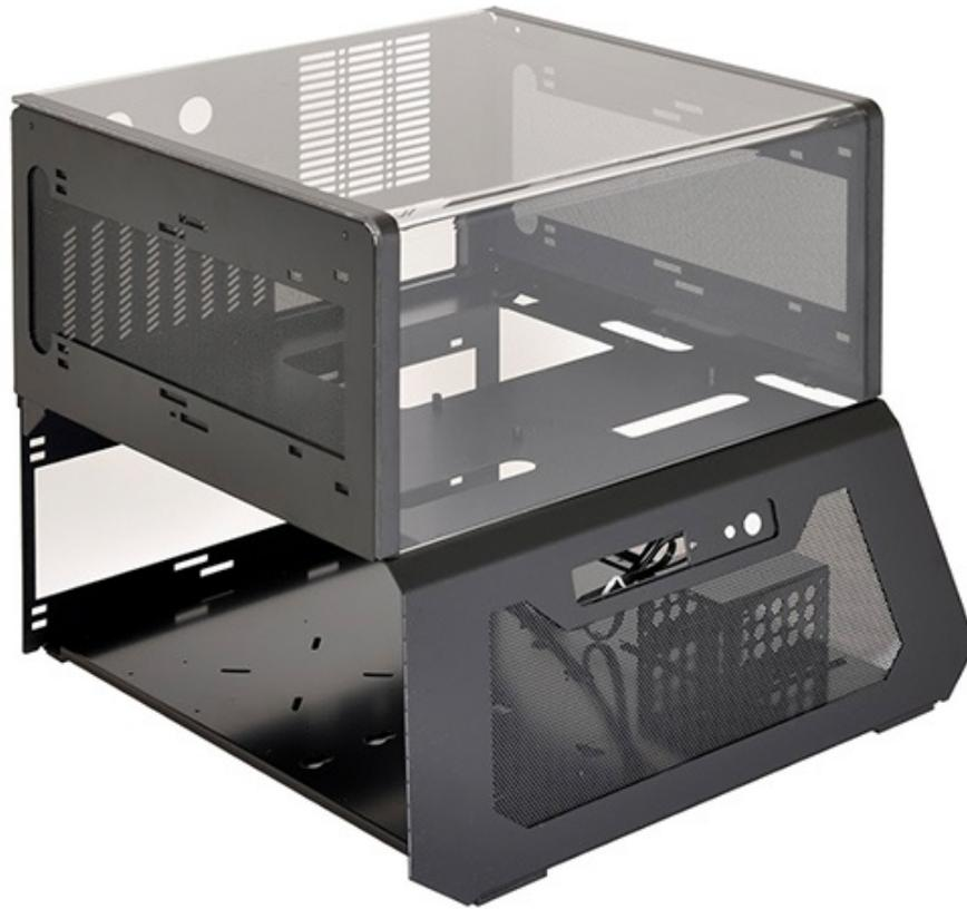
In aggiunta sarà possibile acquistare il T70-1 Upgrade Kit composto da pannelli laterali aggiuntivi con predisposizioni per due ventole da 120 o 140mm (e quindi radiatori da 240 e 280mm), un pannello posteriore con predisposizione per ventola da 120 o 140mm ed un coperchio per simulare un case classico, con l'unica limitazione del sistema di raffreddamento ad aria che, in presenza di tale coperchio, non potrà superare i 180mm.
