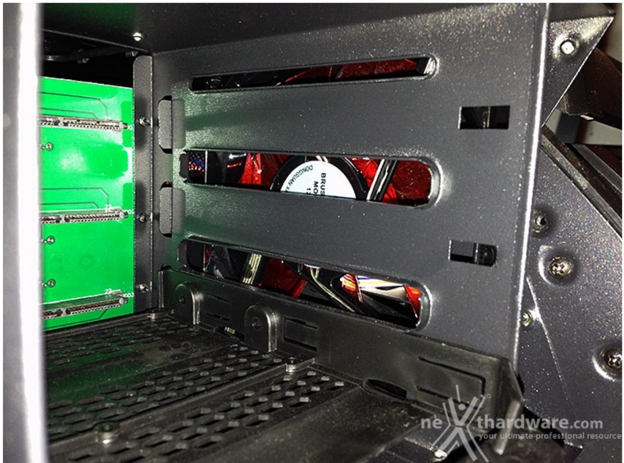
La ventola da 120mm preposta al raffreddamento delle unità di storage non è in alcun modo accessibile, a meno che non vengano rimossi tutti i supporti in plastica del case.
