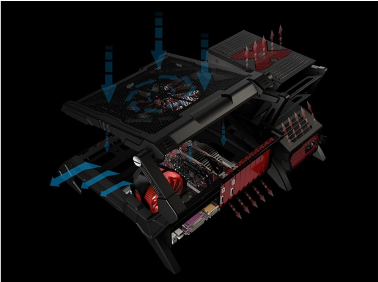
Le griglie poste sul vano alimentatore permetteranno una fuoriuscita rapida del calore trasportandolo verso l'alto.
