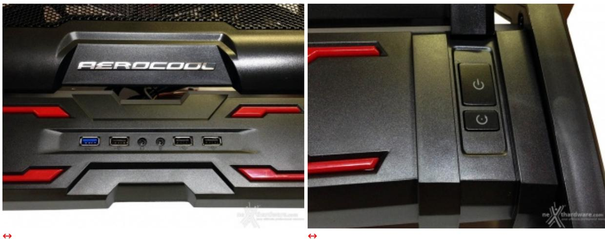
Sul pannello frontale troviamo una porta USB 3.0, due connessioni audio per cuffie e microfono e, infine, tre porte USB 2.0.
