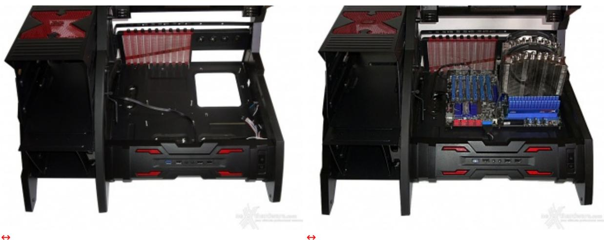
Il primo passo da effettuare è senza alcun dubbio l'installazione della motherboard con relativo dissipatore.
