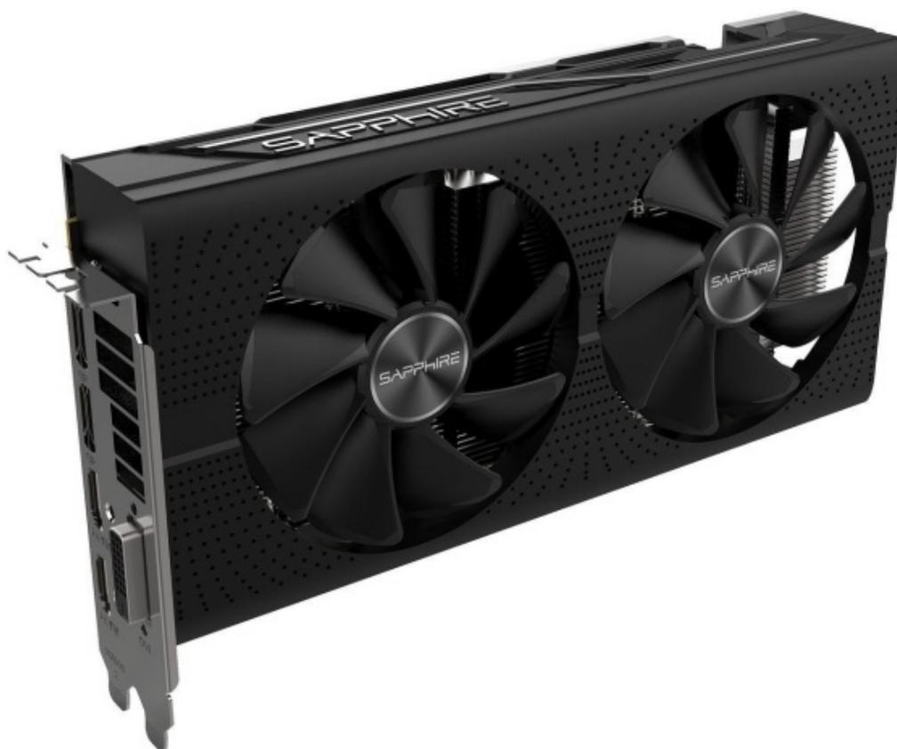
Per i giocatori con un budget leggermente più limitato c'è la SAPHIRE Pulse RX 570, una soluzione ideale per giocare a 1080p equipaggiata con una GPU Polaris 20 Pro integrante 2048 Stream Processors con boost clock da 1284MHz coadiuvati da 4GB di GDDR5 da 7Gbps su un bus a 256 bit per una banda passante di 224 GB/S.
