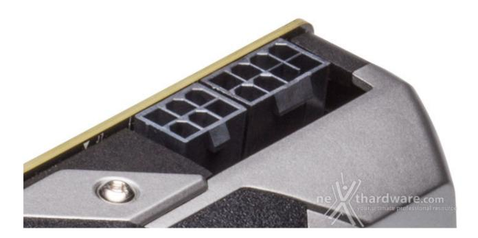
NVIDIA dichiara un TDP (Thermal Design Power) di 230 Watt, valore di poco superiore ai 225 Watt erogabili da 2 connettori di alimentazione PCI-E 6 pin (75 Watt per connettore più 75 Watt dallo slot PCI-E 3.0).
