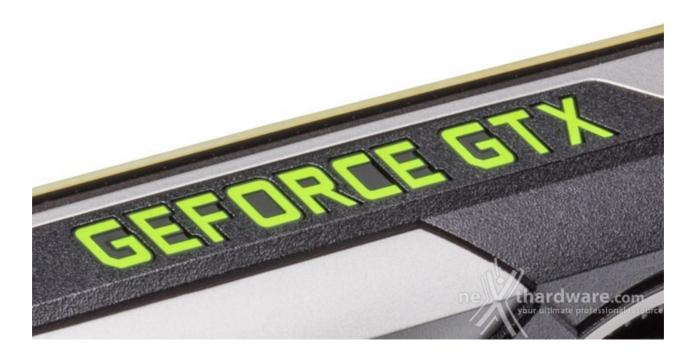
La luminosità del logo è regolabile via software, utilizzando i tool messi a disposizione dai vari partner NVIDIA.
