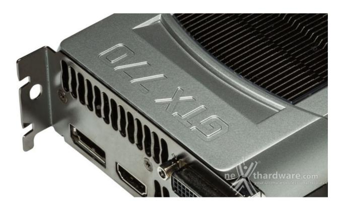
La GeForce GTX 770 è basata sulla GPU NVIDIA GK-104, è dotata di 1536 CUDA Core ed è equipaggiata con 2 o 4GB di memorie GDDR5, per la prima volta operanti alla frequenza di ben 7010MHz.
