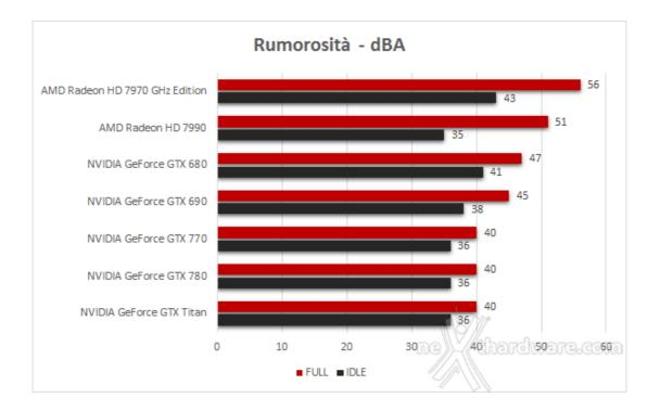
Senza molto stupore, anche la GeForce GTX 770 mostra la stessa rumorosità fatta registrare dalle GeForce GTX 780 e GeForce GTX Titan.
