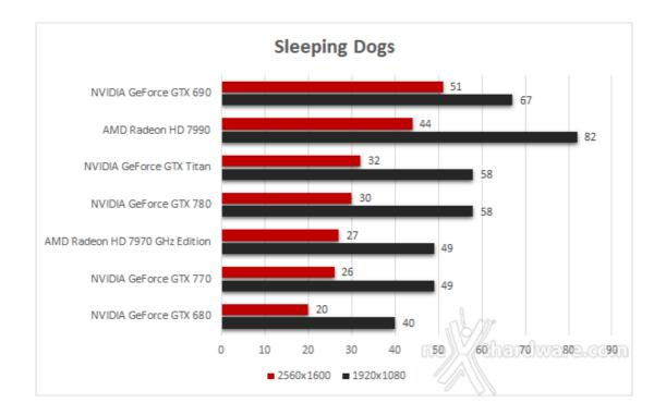
In Hitman: Absolution e Sleeping Dogs, notiamo come la AMD Radeon HD 7970 GHz Edition e la NVIDIA GeForce GTX 770 restituiscano un frame rate medio praticamente equivalente.
