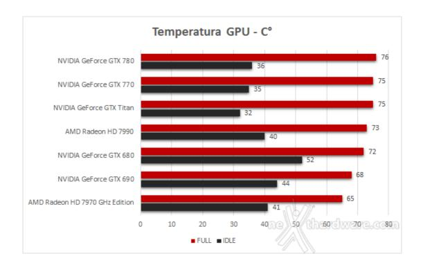
Anche con GeForce GTX 770 osserviamo lo stesso comportamento già analizzato nella GeForce GTX 780 e nella GTX Titan: le temperature in IDLE si mantengono molto basse per poi crescere progressivamente durante un utilizzo intensivo della scheda.
