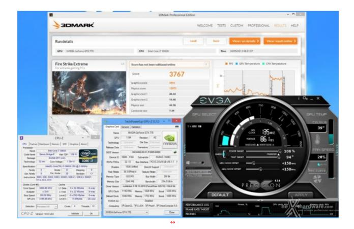
La GeForce GTX 770 mostra una notevole propensione all'overclock, consentendo di aumentare la frequenza di base della GPU sino a +150MHz, senza la necessità di intervenire né sulla tensione di alimentazione della GPU stessa, né sulla velocità della ventola del dissipatore di calore.
