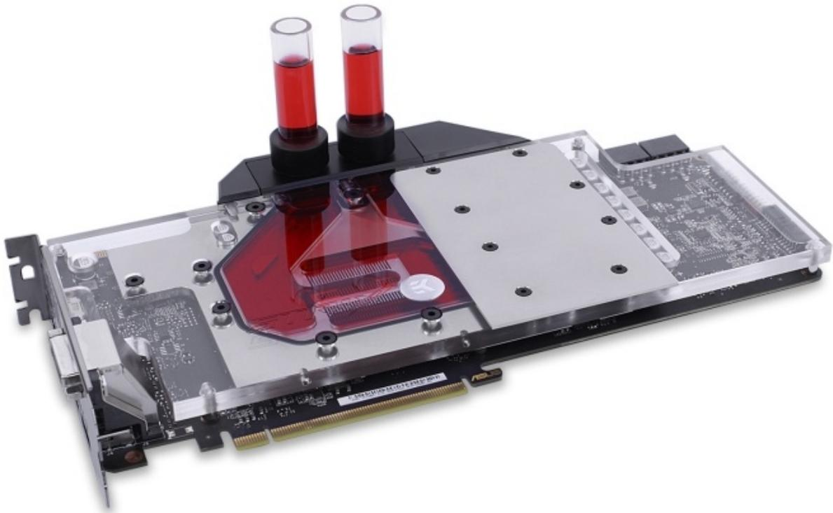
Il liquido refrigerante, infatti, scorre sopra le parti della struttura a diretto contatto con i componenti sopra menzionati, consentendo una elevata stabilità operativa alla scheda anche quando vengono utilizzate
