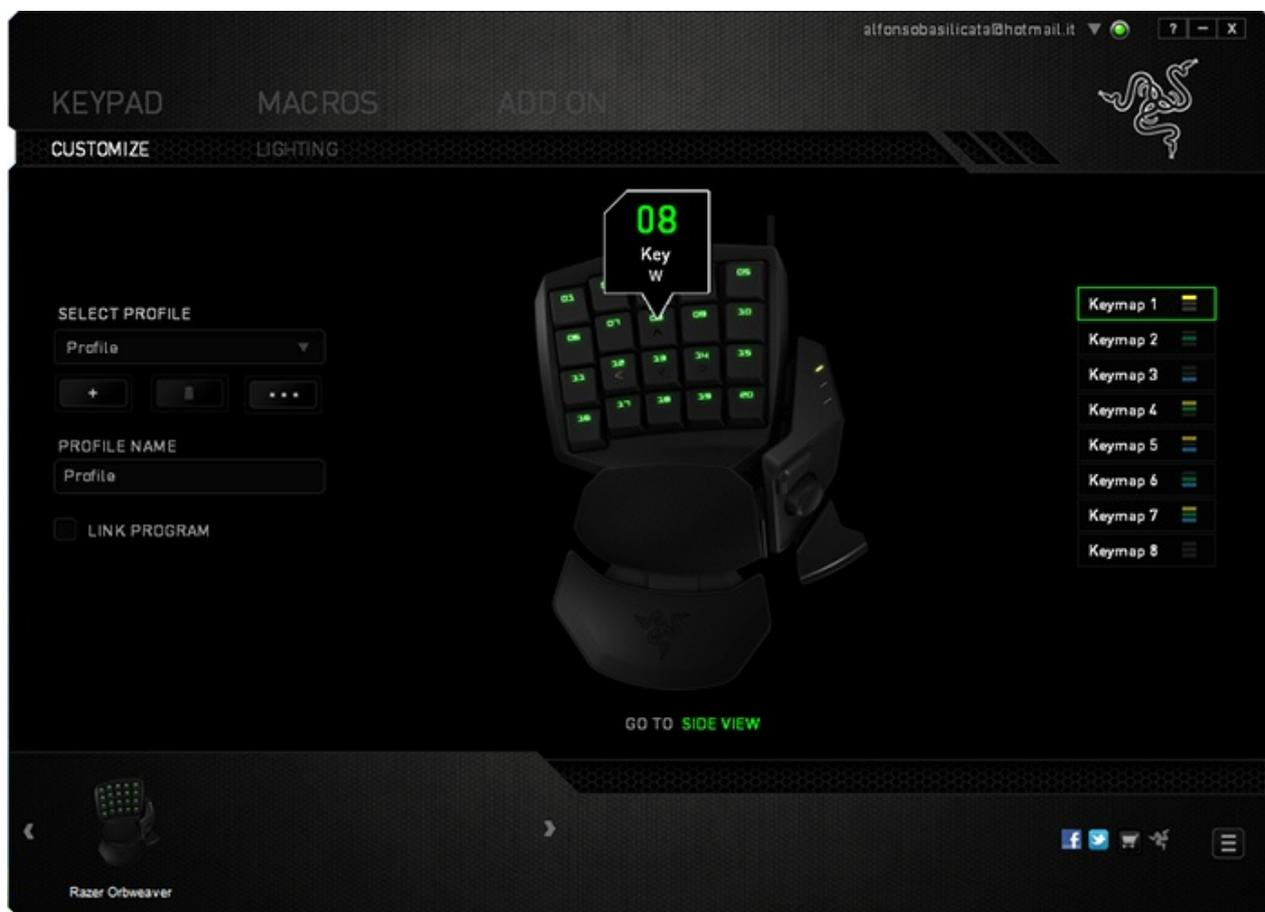
Nella sezione "Customize" potremo gestire i profili, impostando per ogni titolo a nostra disposizione una mappatura dei tasti diversa per ogni eventualità .
