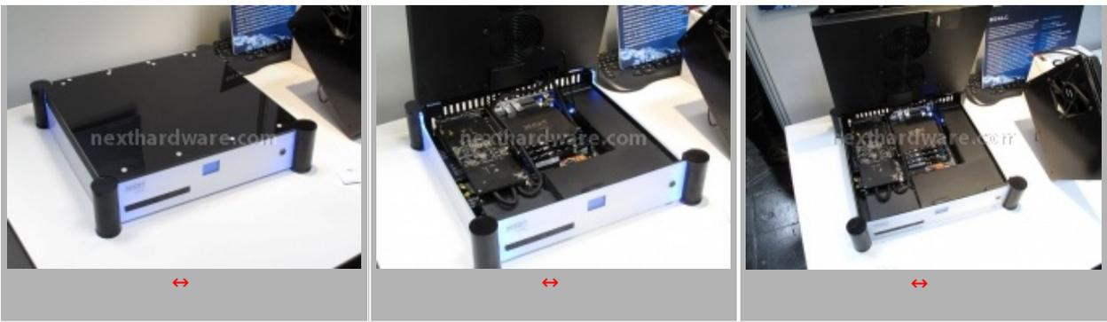
Molto bello sia il case modded, che l'integrazione a liquido. Innovativa la scelta di creare un unico WB per cpu e mosfet e, particolarmente interessante, la disposizione della coppia di radiatori nascosti all'interno del top.
